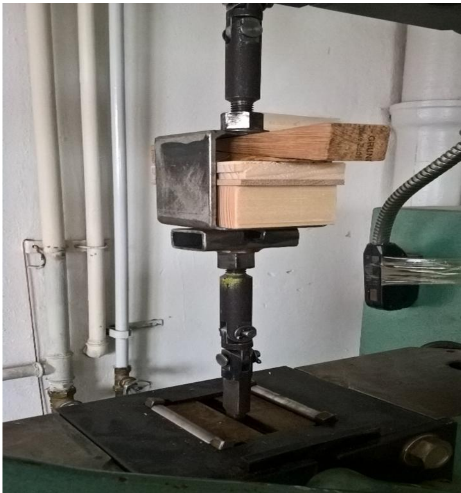
Obr. 10 – Usazení zkušebního dřeva v upínacím přípravku před provedením zkoušky
