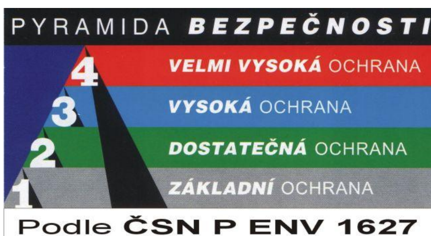
Obr. 2 – Pyramida bezpečnosti podle ČSN P ENV 1627 http://www.adsecurity.cz/katalog/index.php?static_TB=2
