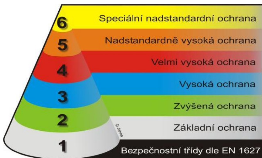
Obr. 1 – Bezpečnostní třídy podle EN 1627 http://www.adsecurity.cz/katalog/index.php?static_TB=2
