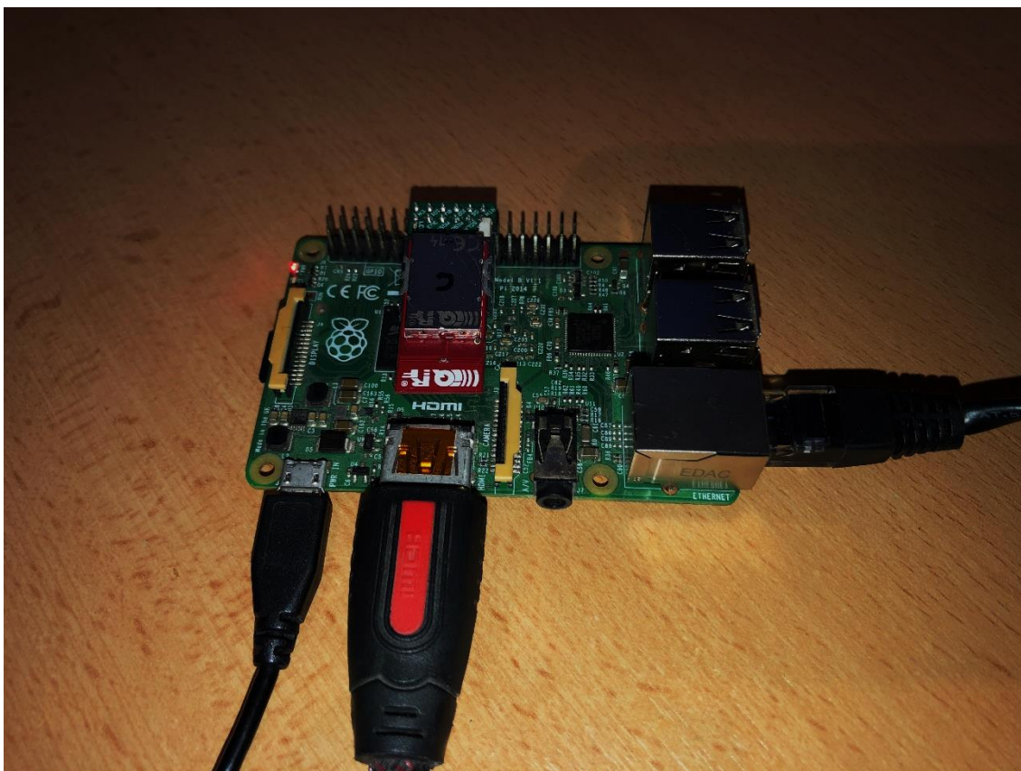
Obr. 32 – Raspberry Pi s připojeným napájením, modulem pro IQRF transceiver, HDMI kabelem pro výstup a ethernetovým kabelem pro připojení k internetové síti (zdroj: vlastní zpracování)
