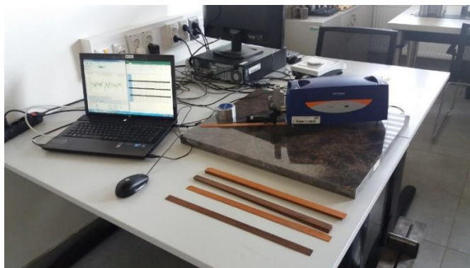
Obr. 31 Kontaktní profilometr FORM TALYSURF 50 Intra
