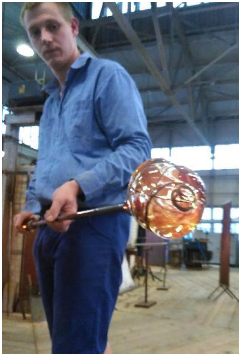
Obr. 18 Proces obalování skloviny čedičovým vláknem
