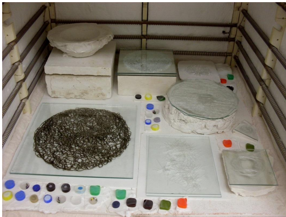
Obr. 15 Vložené formy se skly a vlákny před tavnou
