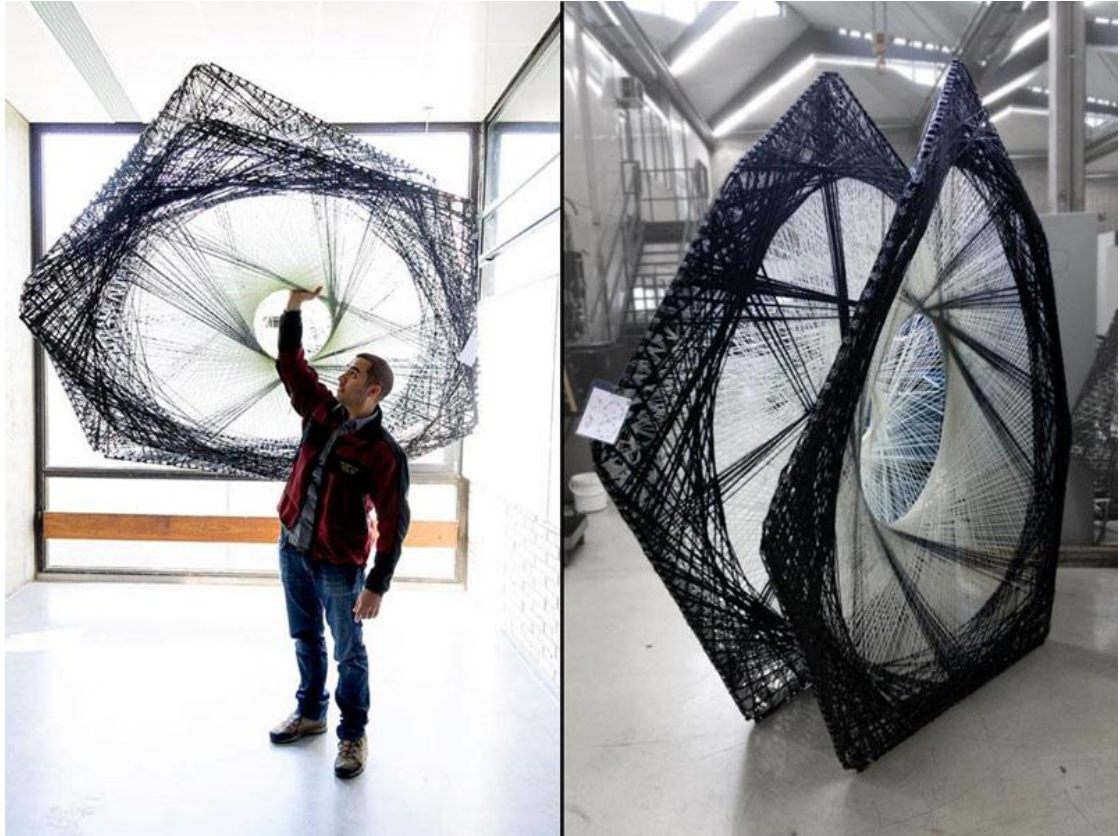
Obr. 11 Roboticky vyrobená vláknitá struktura ze ztužených polymerů © ICD / ITKE University of Stuttgart
