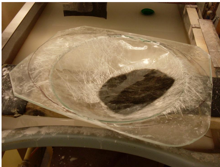
Obr. 17 Předkreslení tvaru mísy před řezáním a broušením
