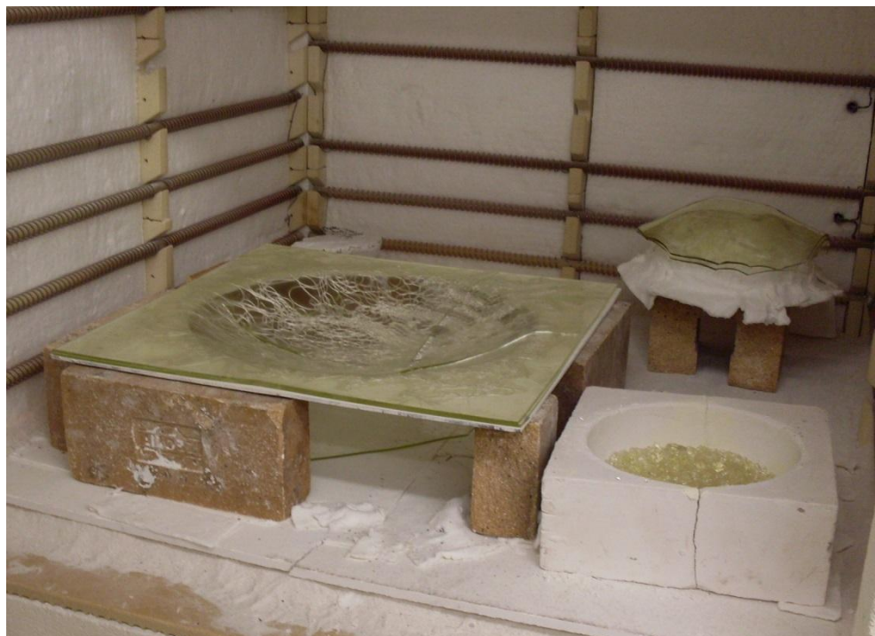
Obr. 16 Vlevo a vzadu - proces ohýbání tabule s vlákny do šablony a formy Vpravo – slinování skleněné drtě (frity) ve formě
