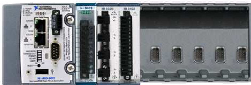
Obrázek 1.8: Řídicí systém CompactRIO s měřicími kartami.
