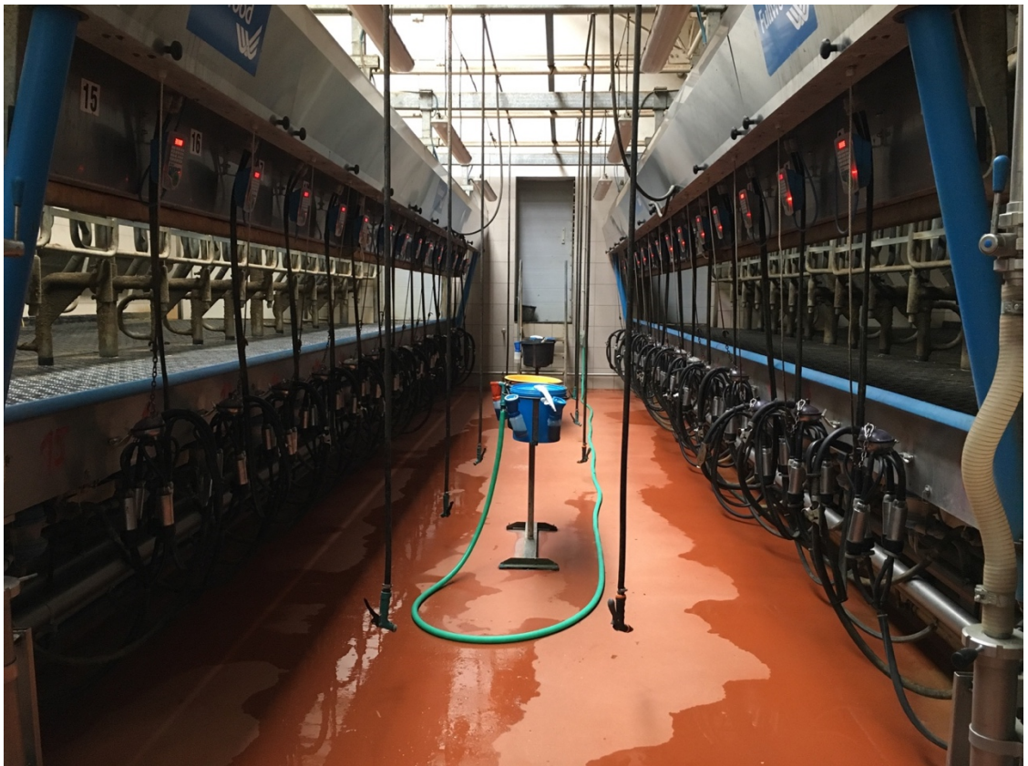
Obr. č. 7 Paralelní dojírna „side by side“ 2x14, Fullwood
