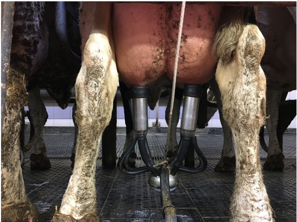
Obr. č. 8 Detail dojícího stroje při dojení
