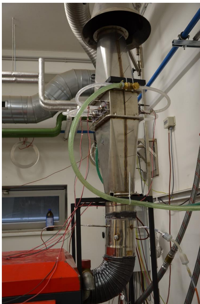
Obr. 26 Sestavený termoelektrický generátor
