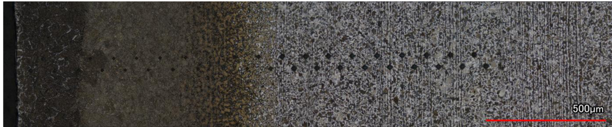
Obr. 48: Mikrostruktura přechodu kalené vrstvy do základního materiálu
