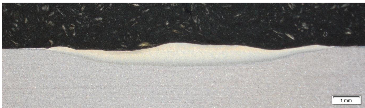
Obr. 44: Vzorek K13 ( \Delta = 0,05 \text{ mm} ; v = 2000 \text{ mm}\cdot\text{s}^{-1} )
