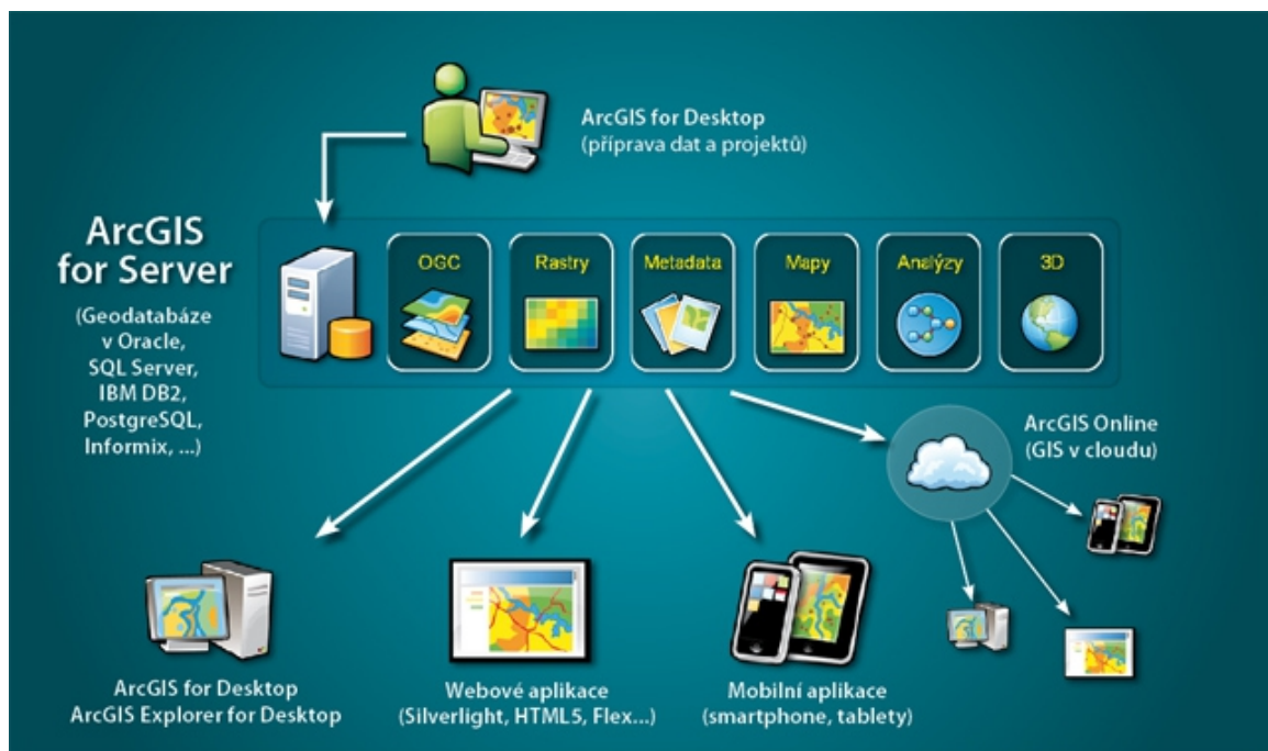
Obr. 4. Schéma architektury technologie ArcGIS for Server (esri, 2013).
