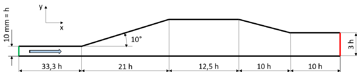
Obrázek 3.3: Náčrt rozměrů asymetrického difuzoru
