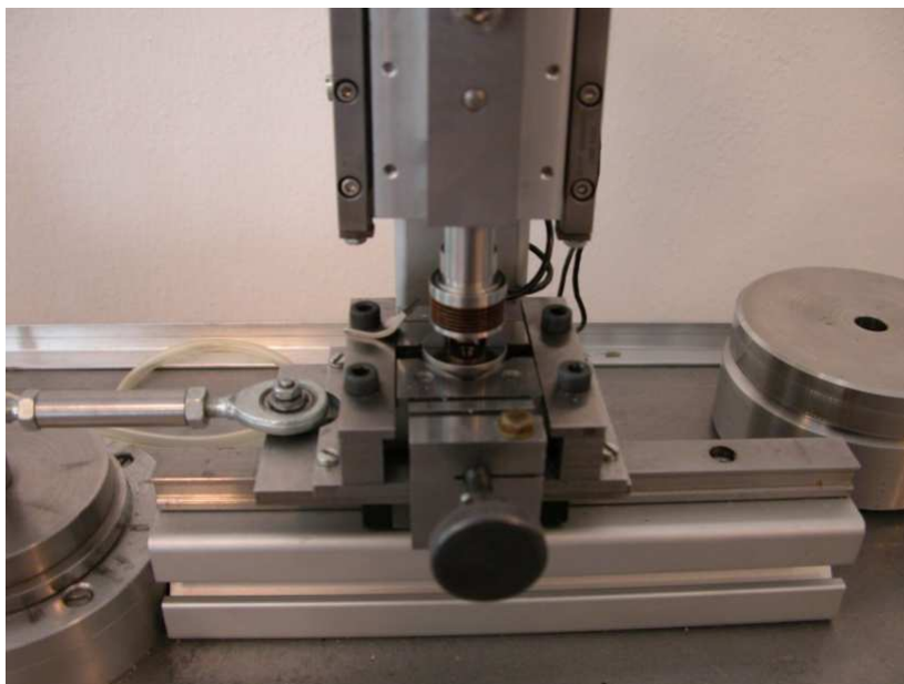
Obrázek 4.3.7. Lineární vratný tribometr (vyvinutý v HVM plasma s.r.o.) [33].
