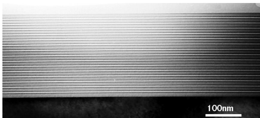
Obrázek 4.1.7. Multivrstva Si-C na křemíku deponovaného v ÚPT - světlé pole.
