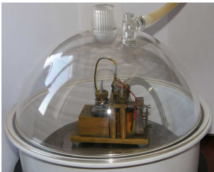
Obrázek 4.2.4. Dynamický tester v komoře pro řízení atmosféry.
