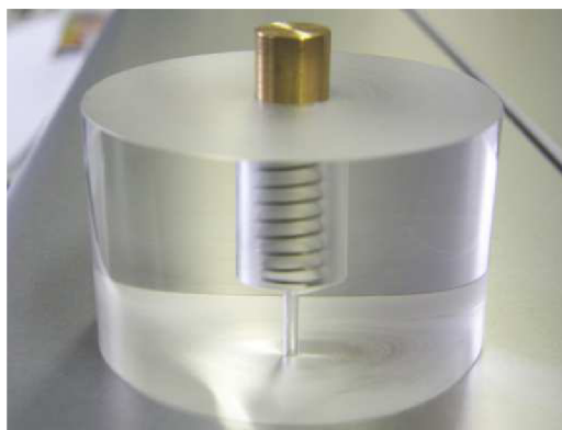
Obrázek 4.1.2. Přípravek pro precizní broušení vzorků
