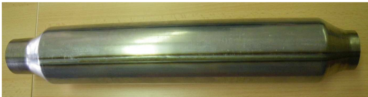
Obr. 5.2 Tlumič výfukového soustavy tvářen za rotace [11]
