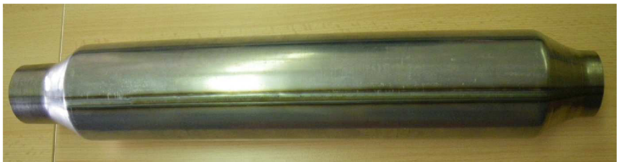
Obr. 5.2 Tlumič výfukového soustavy tvářen za rotace [11]
