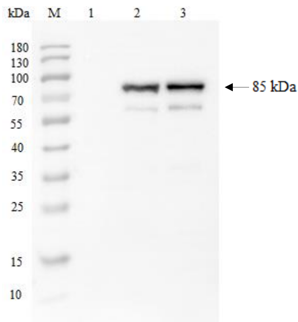
Obr. 12: Western blot - overenie prítomnosti proteínu v lyzáte. Číslo 1 označuje neindukovanú vzorku v čase 0h, číslo 2 označuje indukovanú vzorku po 1h a číslo 3 označuje indukovanú vzorku po 3h. Indukované vzorky boli vizualizované protilátkou anti-His-tag. Písmeno M označuje proteínový marker (Unstained protein ladder) (Thermo Scientific).
