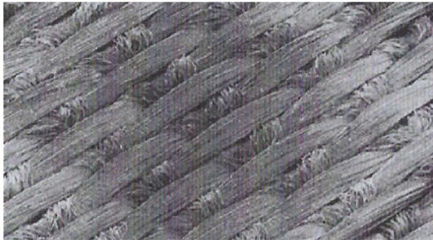
Obrázek 4: Horní povrch pletené geotextilie (Ponikelský a kol., 2011)
