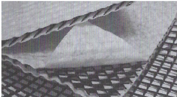
Obrázek 13: Drenážní geokompozit s geosítí (Ponikelský a kol., 2011)
