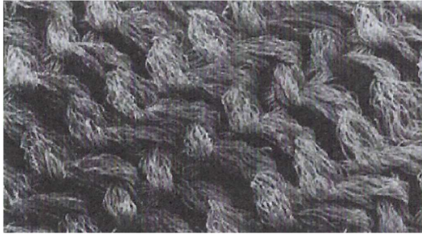
Obrázek 3: Spodní povrch pletené geotextilie (Ponikelský a kol., 2011)
