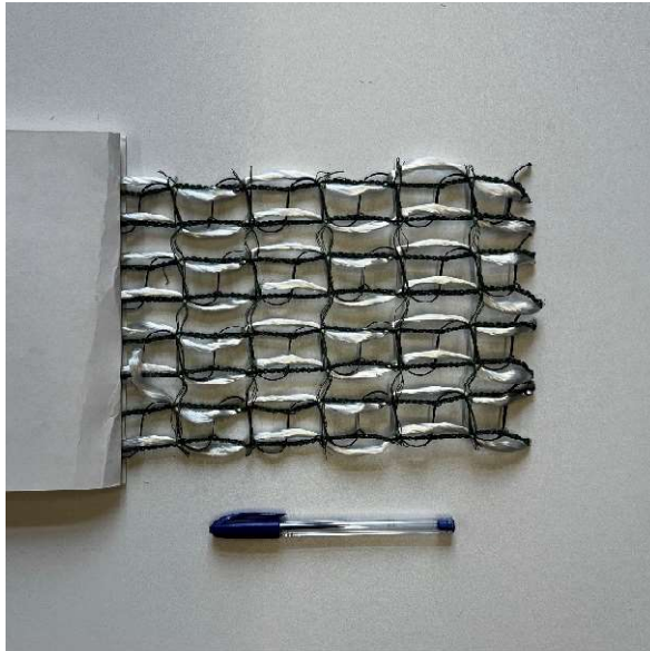
Obrázek 45: 3D kompozitní síť (Nývlt, 2023)
