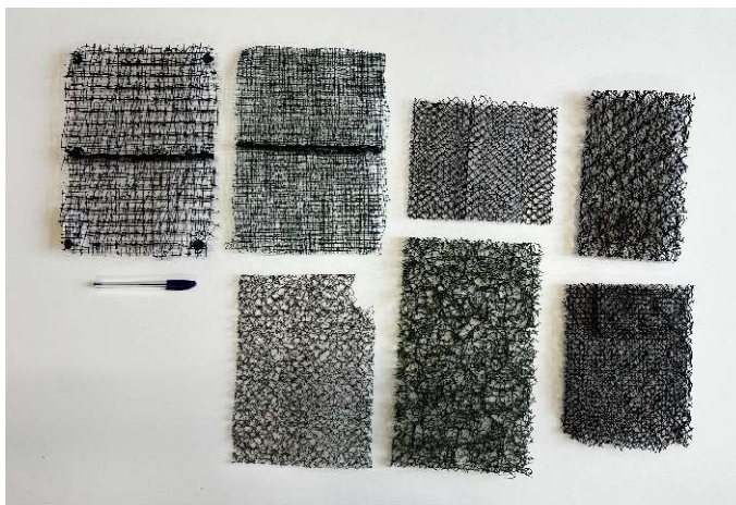
Obrázek 22: Různé druhy georohoží (Nývlt, 2023)
