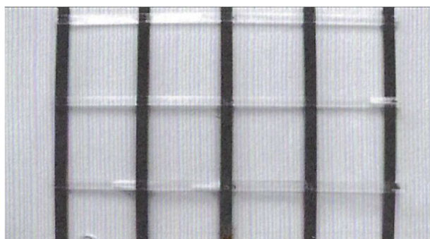
Obrázek 9: Extrudovaná spojovaná geomříž (Ponikelský a kol., 2011)
