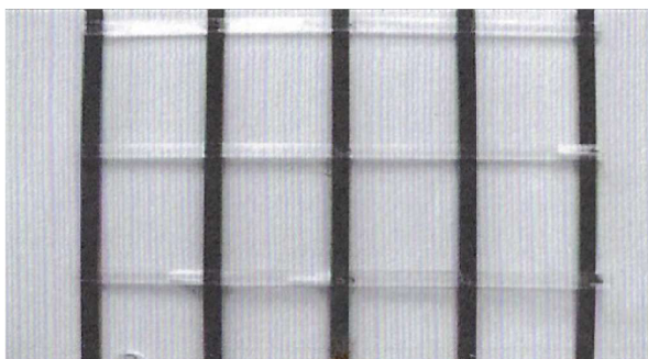
Obrázek 9: Extrudovaná spojovaná geomříž (Ponikelský a kol., 2011)
