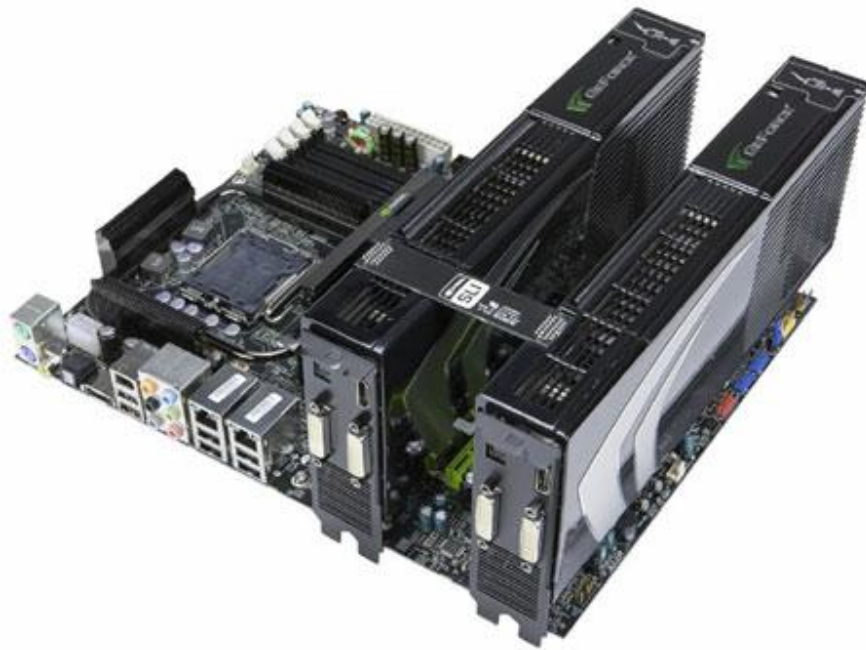
Obrázek 2 - Dvě grafické karty nVidia zapojené přes SLI[16]
