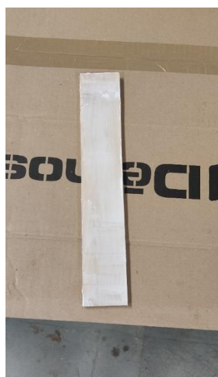
Obrázek 11: Lamela po rozetření PVAc lepidla (zdroj: autor práce)
