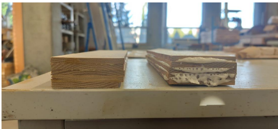
Obrázek 13: Porovnání lepených spár vlevo PVAc, vpravo PUR (zdroj: autor práce)
