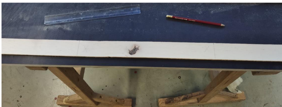
Obrázek 7: Vyselektování vad jednotlivých lamel (zdroj: autor práce)
