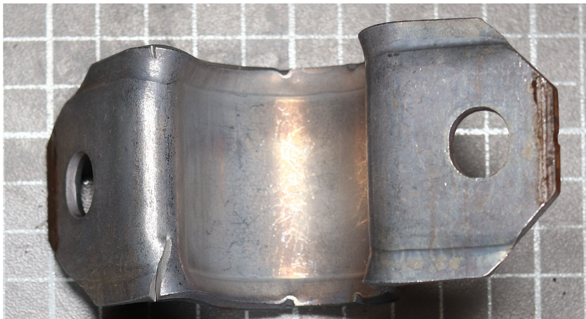
Obrázek 3.3.2-7: Trhlinka na vzorku G2
