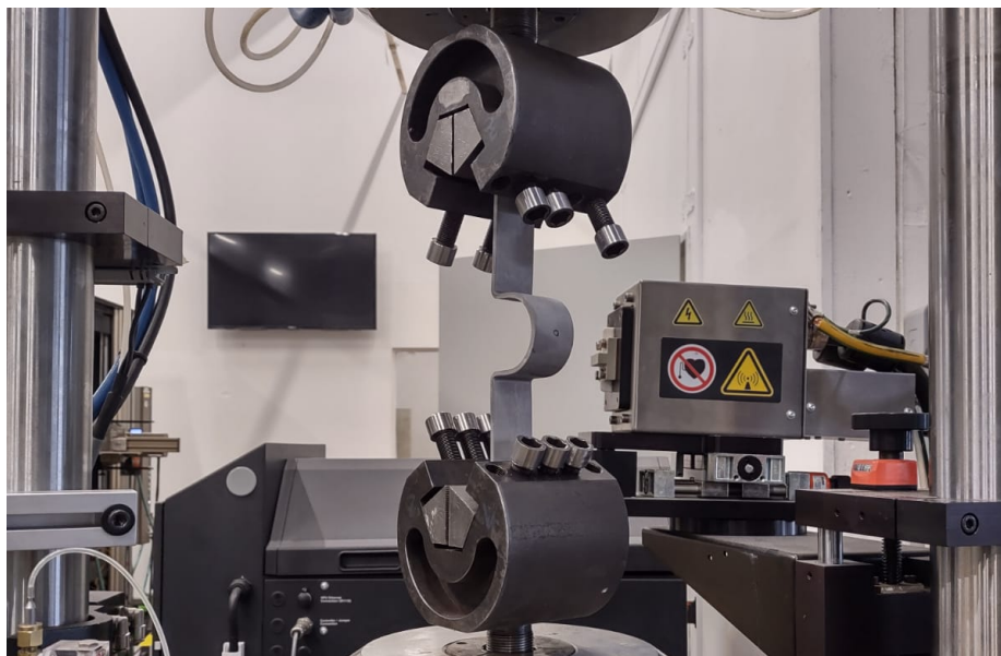
Obrázek 3.3.2-4: Upnutí vzorku B1/B2 ve zkušebním stroji
