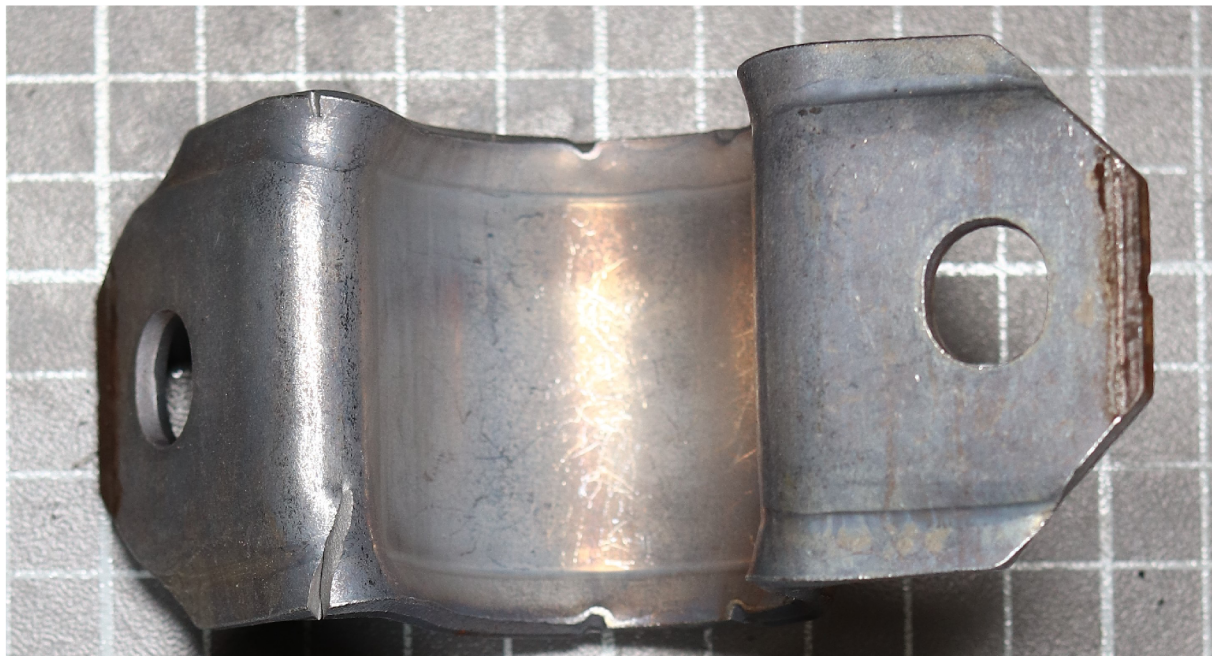
Obrázek 3.3.2-7: Trhlinka na vzorku G2
