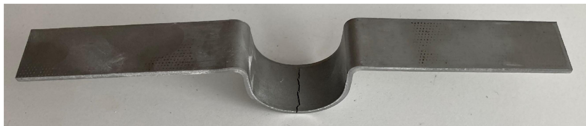
Obrázek 3.4.5-2: Vzorek E1 po testu
