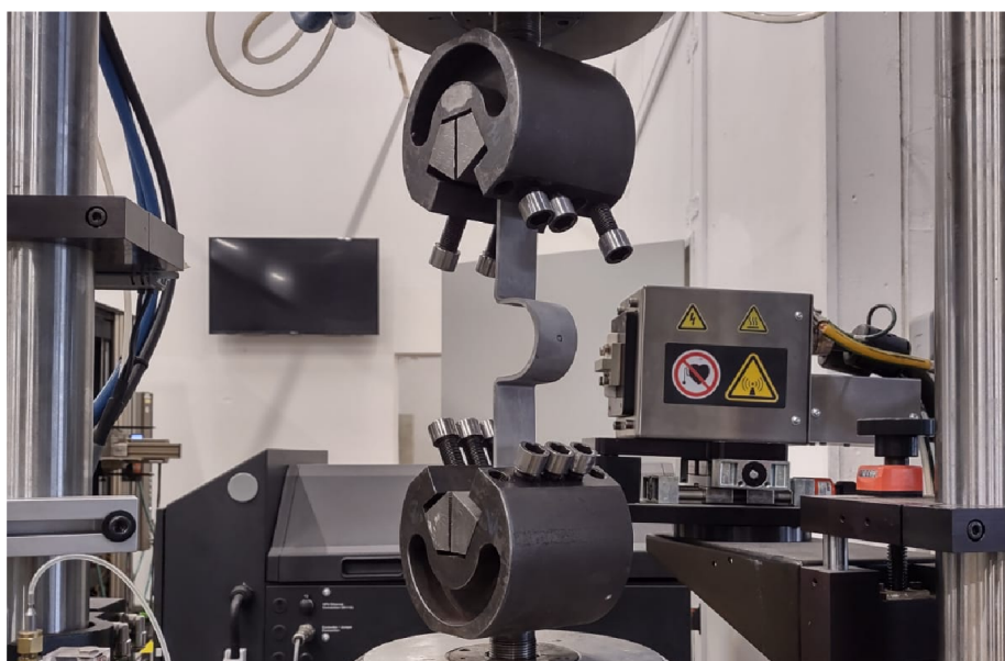
Obrázek 3.3.2-4: Upnutí vzorku B1/B2 ve zkušebním stroji
