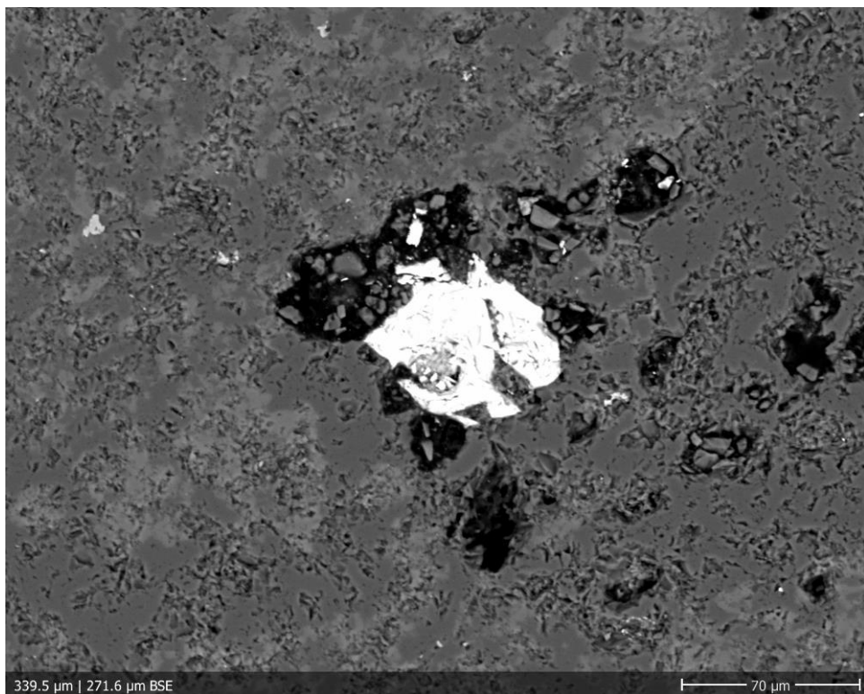
Obr. 22 Fotografie zirkonu ve vzorku berounské křemité horniny Beroun1 v odražených elektronech (BSE) pod SEM
