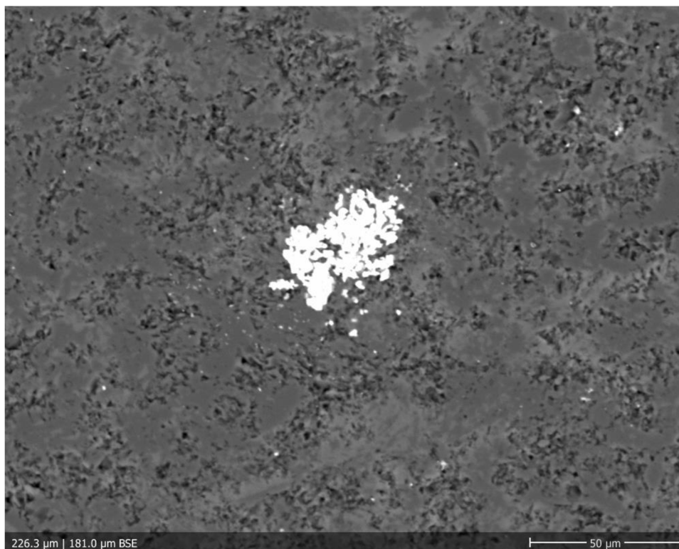
Obr. 21 Fotografie xenotimu ve vzorku berounské křemité horniny Beroun1 v odražených elektronech (BSE) pod SEM
