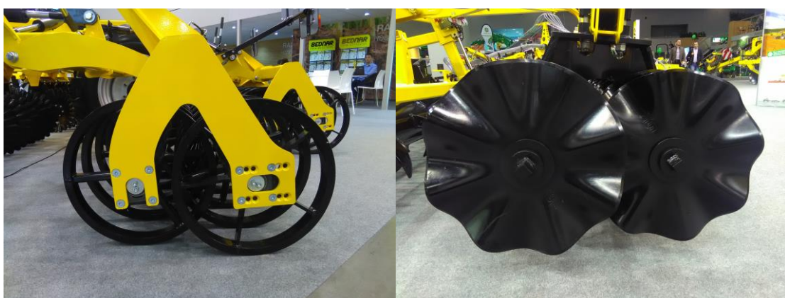
Obr. 35 Dvojitý kotoučový válec a dvojitý válec se zvlněnými talíři–koltry (Auer, 2016).
