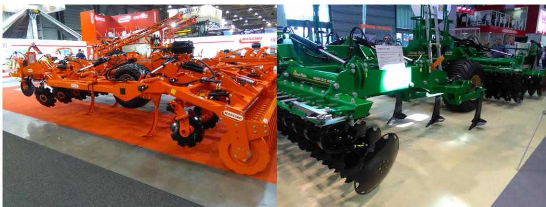
Obr. 17 Kombinace dlátového a talířového kypřiče Maschio a Simba (Auer, 2016).
