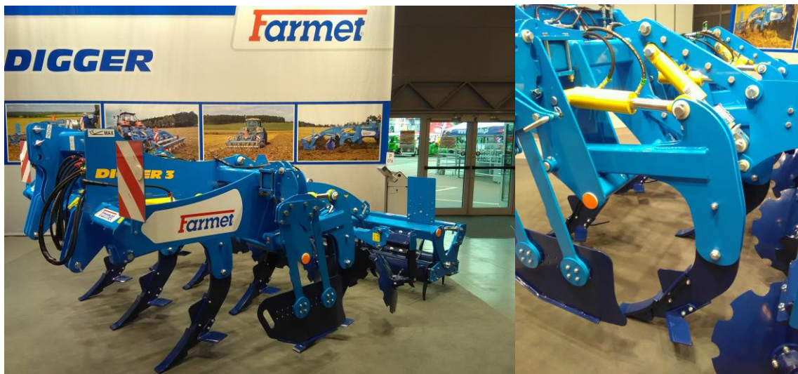
Obr. 13 Dlátový kyprič Farmet Digger s dvojitým hřebovým válcem (Auer, 2016).
