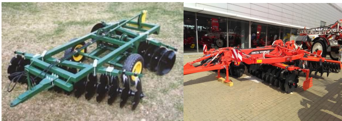
Obr. 26 Talířový kypřič do V - Kovo Novák a do X – Kuhn Discolander (Auer, 2016).
