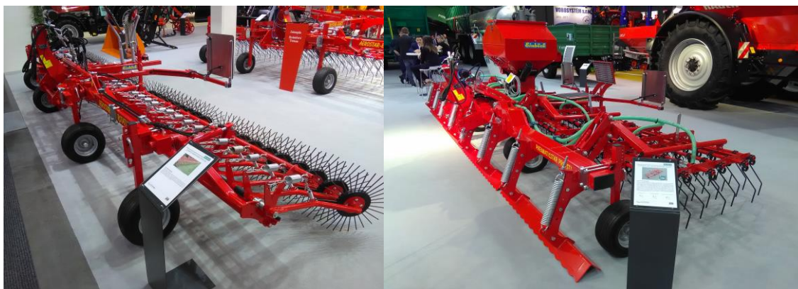
Obr. 7 Rotační prutové brány Einböck Aerostar Rotation a kombinace prutových bran se smykovou lištou a přisevem (Auer, 2016).
