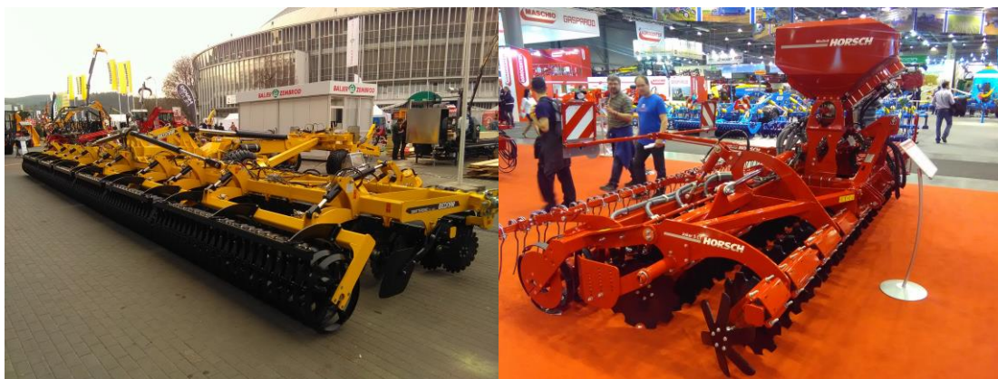
Obr. 27 Talířový kypřič Bednar Swifterdisc o záběru 14 m s jednotlivě uloženými talíři na slupici, nesený kypřič Horsch Joker 5CT s přísevem meziplodin (Auer, 2016).
