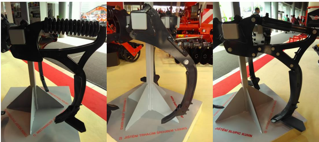
Obr. 25 Jištění slupic vinutými pružinami, jištění střížným šroubem a hydraulické jištění slupic Kuhn (Auer, 2016).
