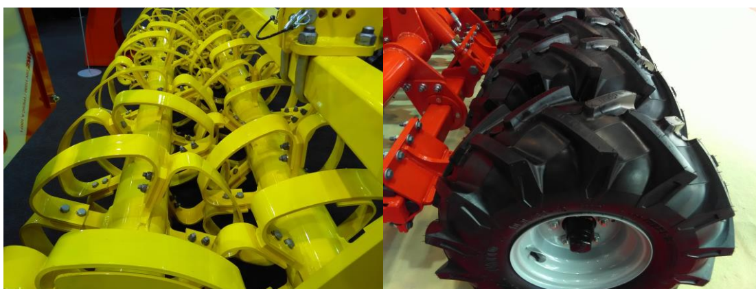
Obr. 37 Dvojitý válec s pružných kotoučů a válec s pneumatik (Auer, 2016).
