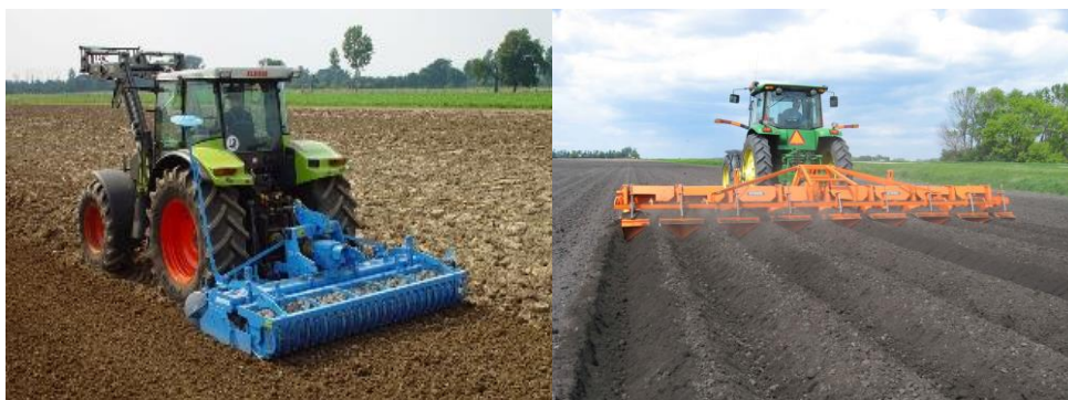
Obr. 8 Rotační kypřič (Lemken) a kypřič s horizontálním rotorem (Struik).
