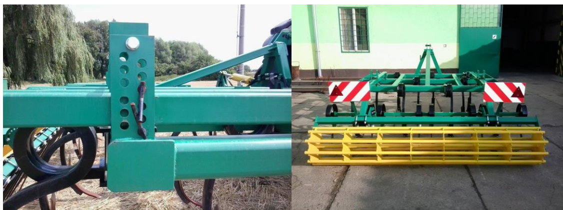
Obr. 45 Nastavení pracovní hloubky kypřiče a rovnací válec (Auer, 2013).
