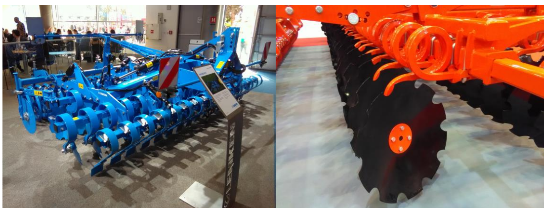
Obr. 30 Jištění pružnými slupicemi Lemken a Maschio (Auer, 2016).
