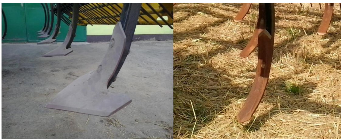
Obr. 42 Šípová radlička pro podmítku a oboustranná radlička vhodná na hlubší kypření (Auer, 2016).
