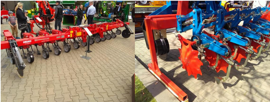
Obr. 6 Radličková plečka Kongskilde a plečka Hatzenbichler (Auer, 2016).
