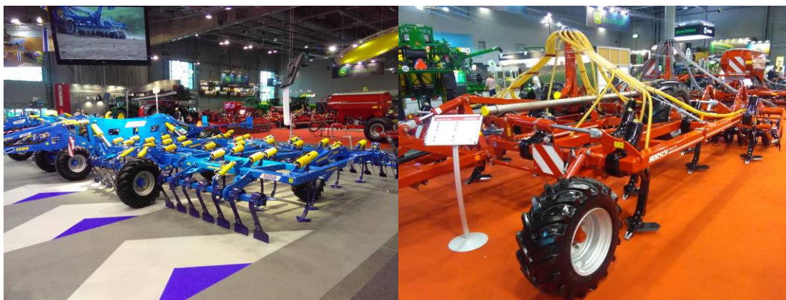
Obr. 22 Radličkový kypřič Farnet Fantom o záběru 12,5 m a kypřič Horsch Terrano 5FM s možností zapravení hnojiva do půdy (Auer, 2016).
