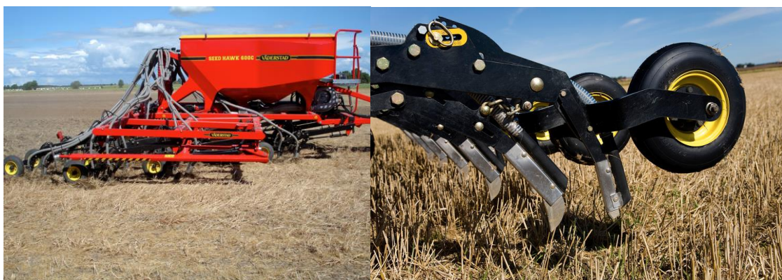
Obr. 21 Secí stroj Väderstad Seed Hawk pro přímé setí se zařízením pro aplikaci minerálních hnojiv (Agrall).
