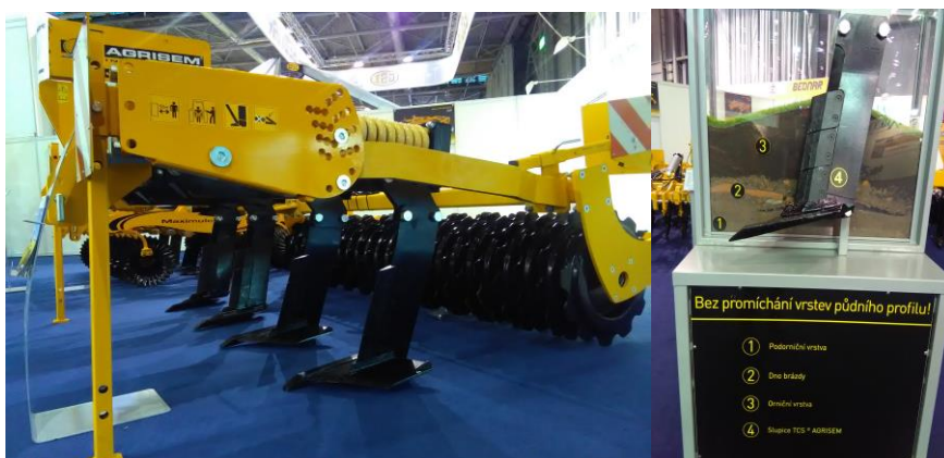
Obr. 3 Hloubkový kypřič Agrisem Cultiplow (Auer, 2016).
