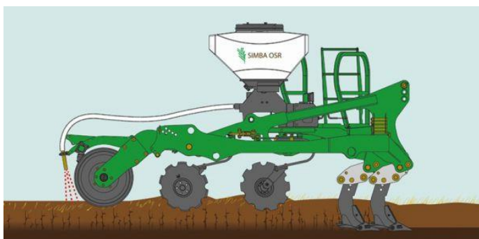
Obr. 16 Kombinace dlátového a talířového kypřiče s přívěsem mezplodin (AGRICIS).
