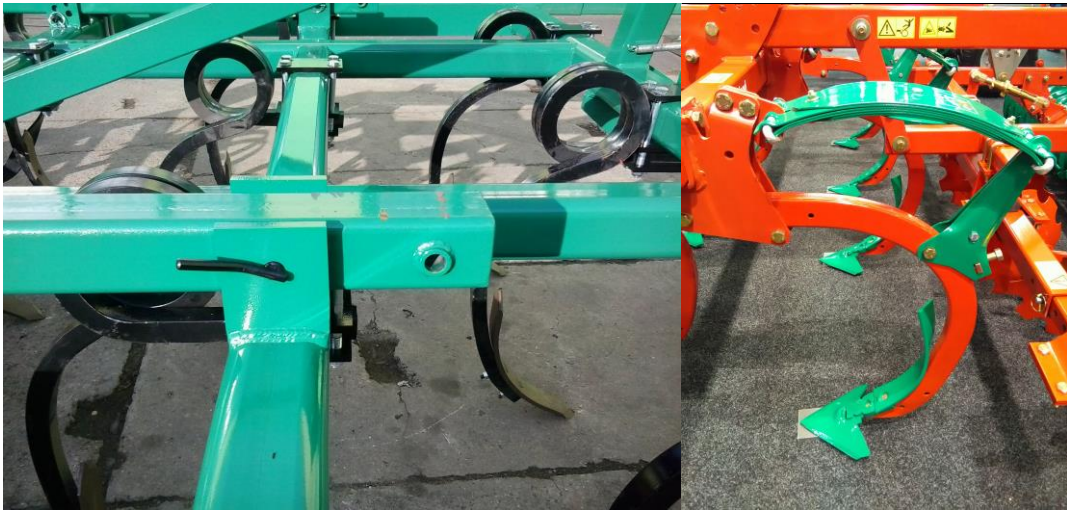
Obr. 24 Jištění pružnou slupicí a jištění listovým perem (Auer, 2016).
