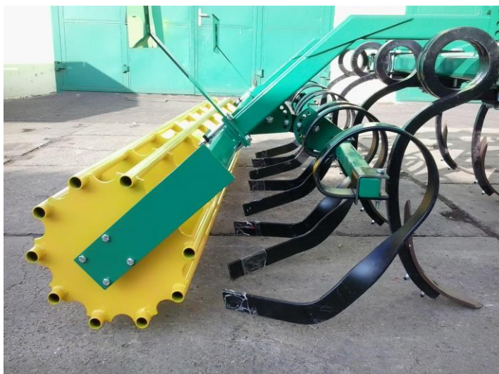
Obr. 44 Zahrnovací pera u radličkového kypřiče (Auer, 2014).
