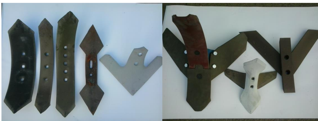
Obr. 23 Kypřicí radličky oboustranné o šířce 130, 70, 100 stočená, 110 mm, šípová kypřicí radlička a sestavy kypřících těles o různém tvaru a pracovní šířce (Auer, 2015).
