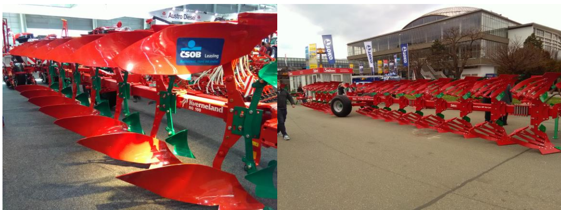
Obr. 2 Pluh polonesený otočný s předradličkami Kverneland a dvanácti radličný pluh s páskovými odhrnovačkami Sukov ArcoAgro (Auer, 2016).
