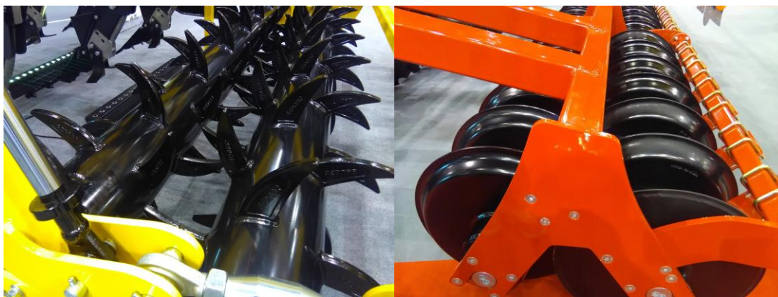
Obr. 36 Dvojitý hřebový válec a dvojitý diskový pěch (Auer, 2016).
