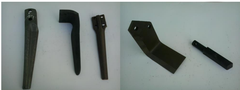
Obr. 9 Pracovní nástroje rotačního kypřiče a kypřiče s horizontálním rotorem (Auer, 2015).
