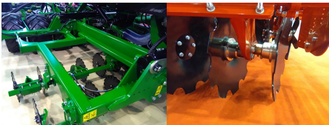
Obr. 28 Zvlněný talíř – koltra a vykrajovaný talíř (Auer, 2016).
