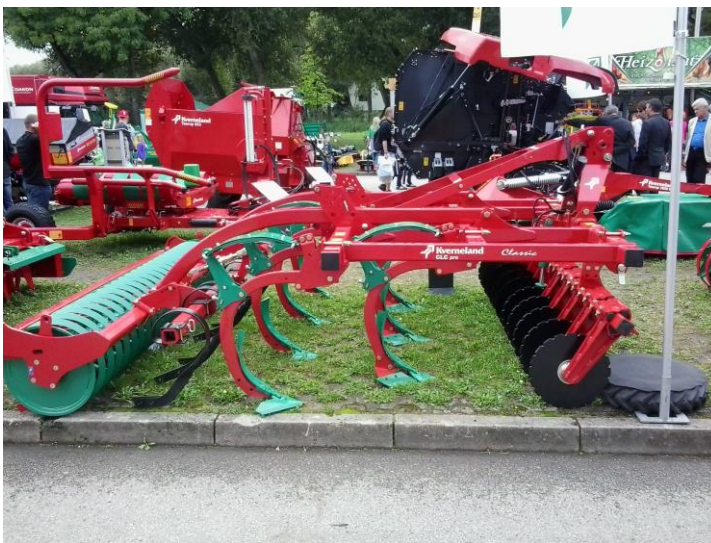
Obr. 14 Kombinace talířového a radličkového kypříče (Auer, 2014).
