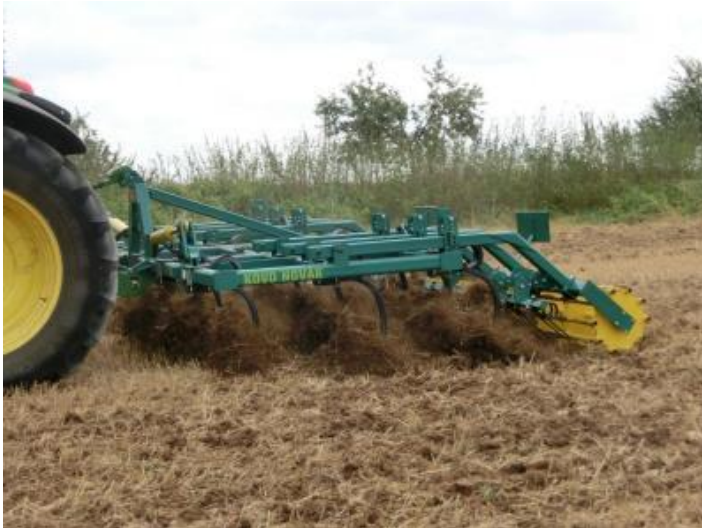
Obr. 40 Radličkový kypřič při práci (Auer, 2013).
