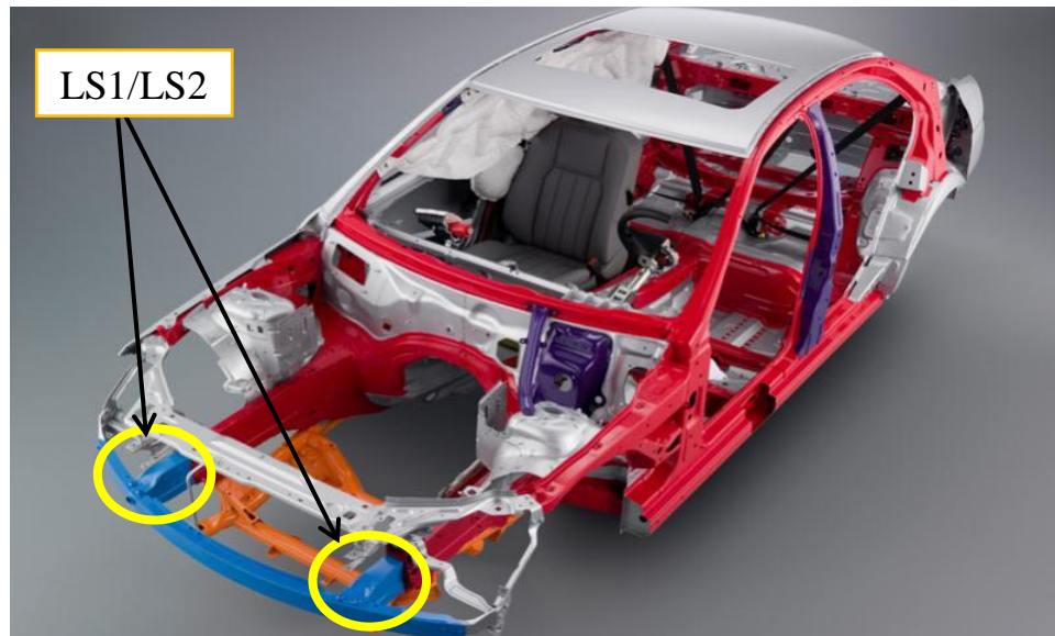
Obr. 8: Deformační zóny karoserie [29]
