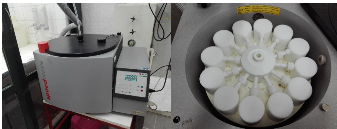
Obrázek č. 5: Mikrovlnná pec a umístění TMF do rotoru pece (autor práce).
