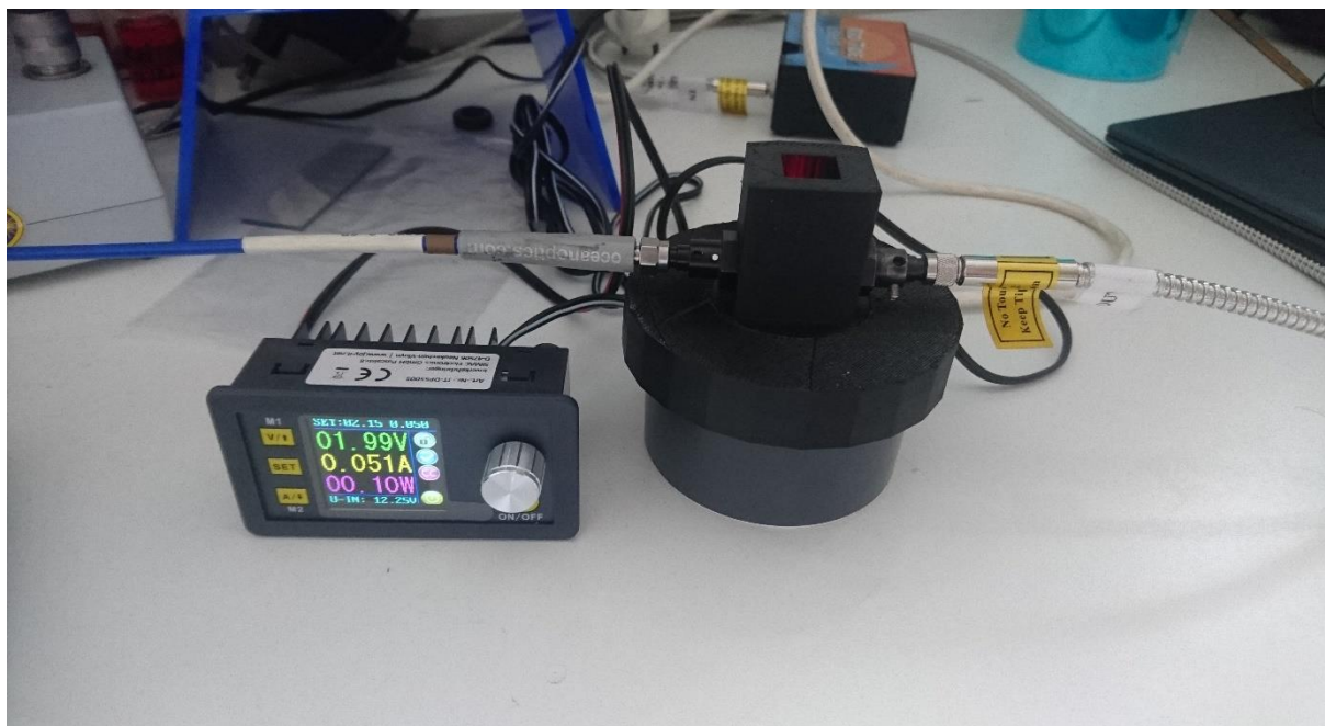
Obr. 9 Pohled na měřicí aparaturu: držák na kyvety s kolimátory a optickými vlákny, pod ním magnetická míchačka, zdroj elektrické energie, v pozadí spektroskop RedTide.
