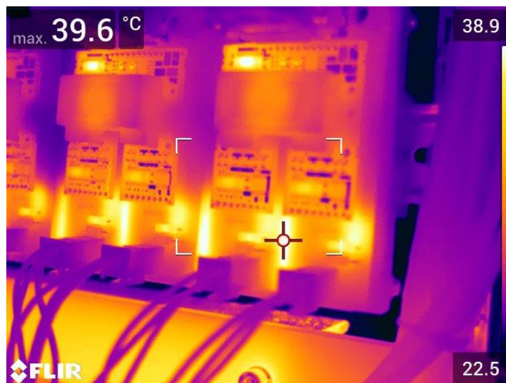
Obrázek 65 Termální snímek budičů tranzistoru
