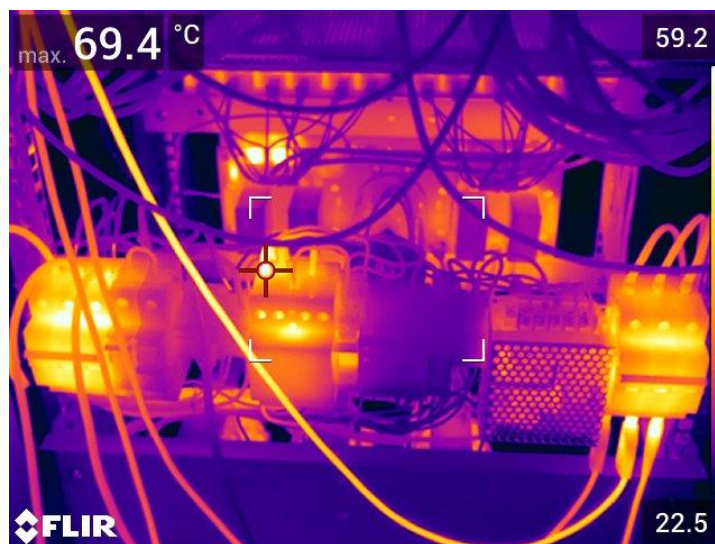
Obrázek 64 Termální snímek připojovacích prvků
