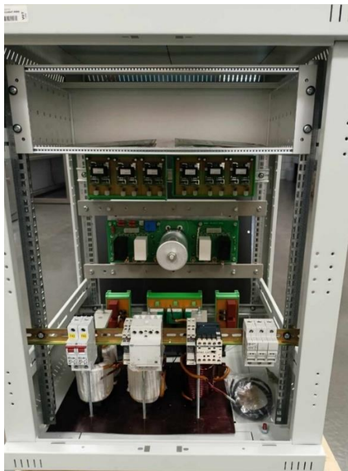
Obrázek 26 Kompletní uspořádání měniče
