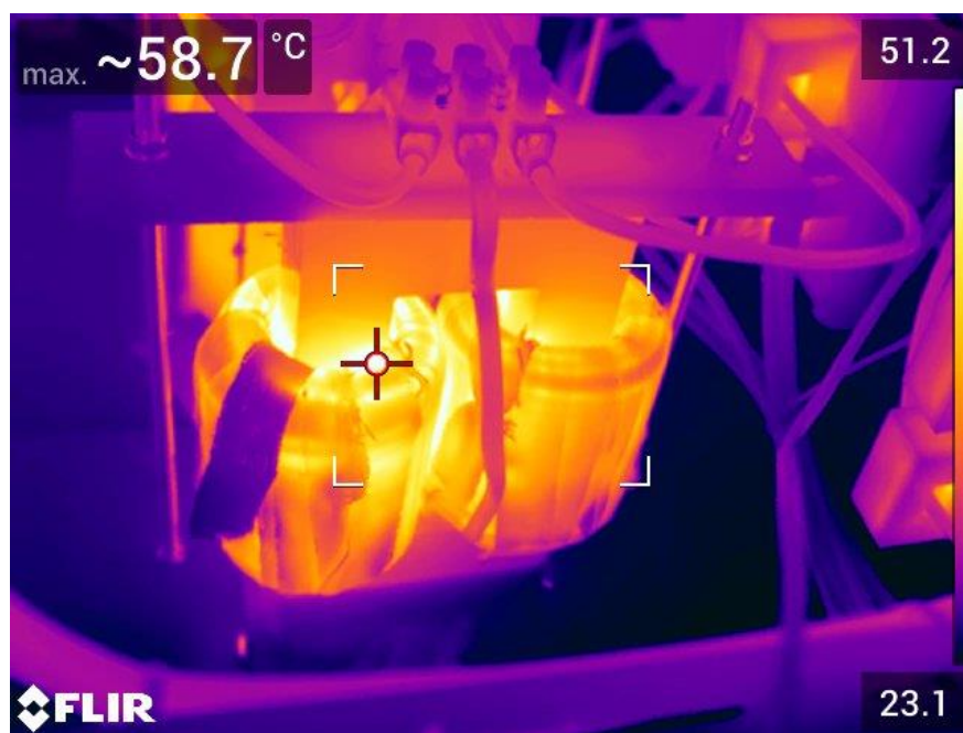
Obrázek 66 Termální snímek síťové tlumivky
