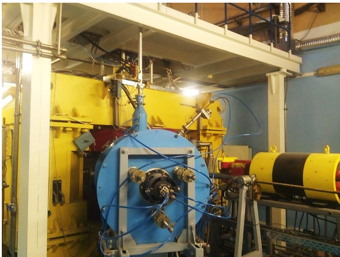
Obrázek č. 13: Magnetické jádro urychlovače IC – 100, nad jádrem je umístěna plošina s iontovým injektorem, vpravo od jádra je umístěna „hlaveň“ urychlovače.
