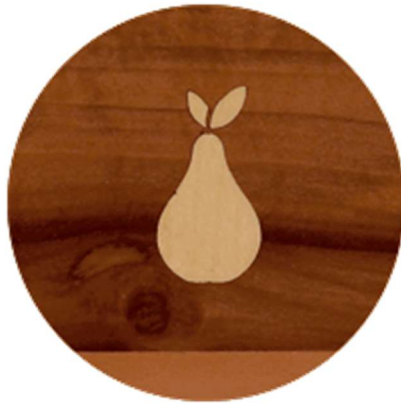
Obrázek 2: Příklad laserového řezání intarzií z dýhy
