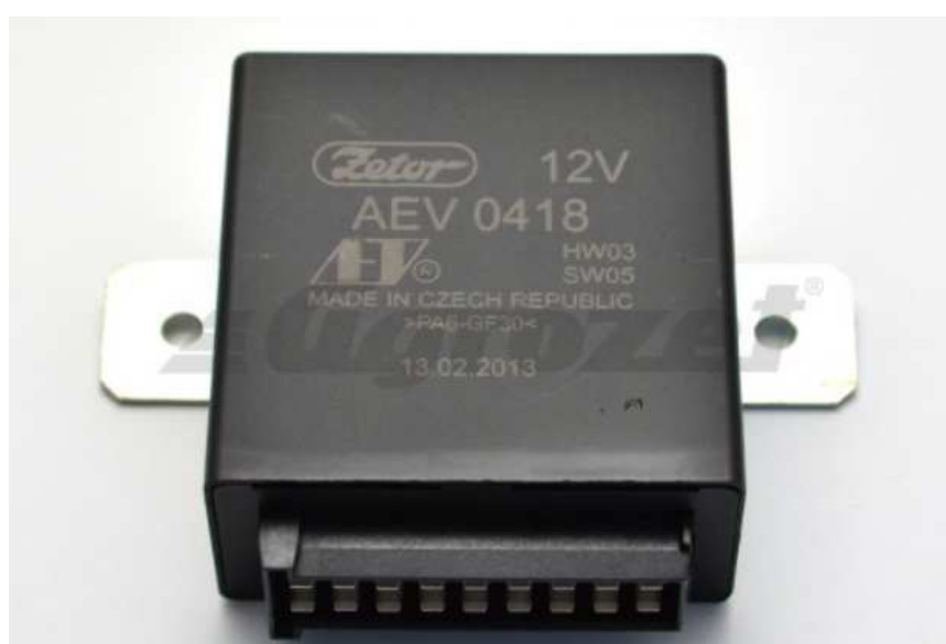
Obr. 2.1 – Řídicí jednotka převodovky traktoru ZETOR Forterra Classic (Agrozet, 2017 [online])
