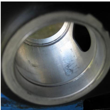
Obr. 28: Středový domek pro středové složení BB30 [41]
