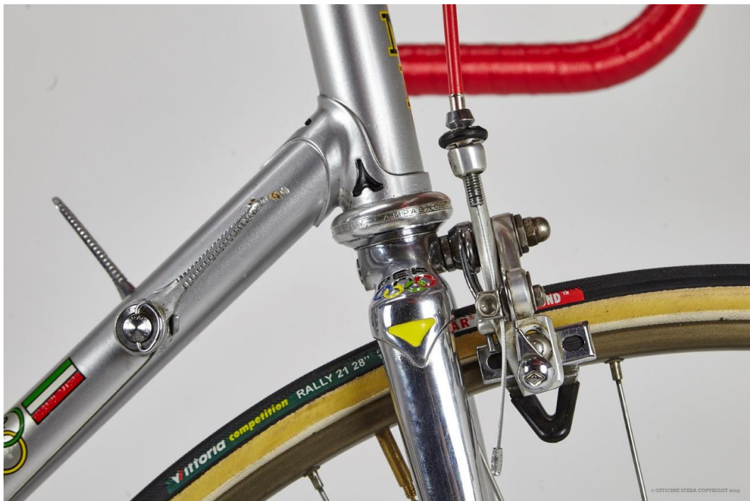
Obr. 8: Detailní pohled na spojení trubek pomocí mufní [9]
