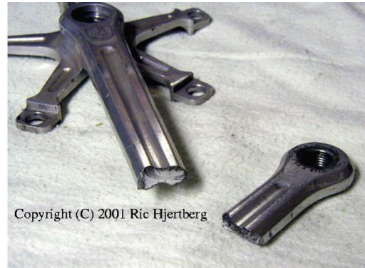
Obr. 39: Selhání kliky v oblasti největšího smykového napětí [53]
