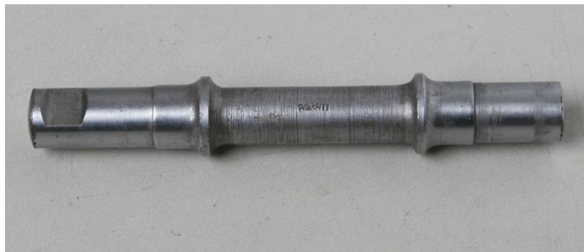
Obr. 17: Klínková středová osa pro seřiditelné středové složení [22]
