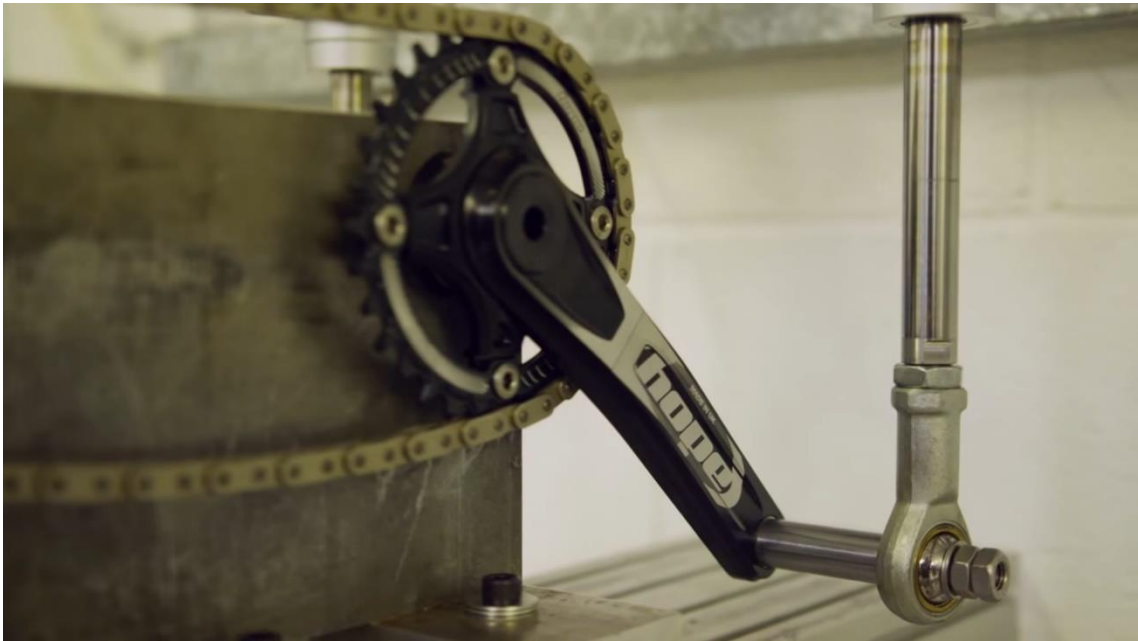
Obr. 33: Test simulující šlapání [48]
