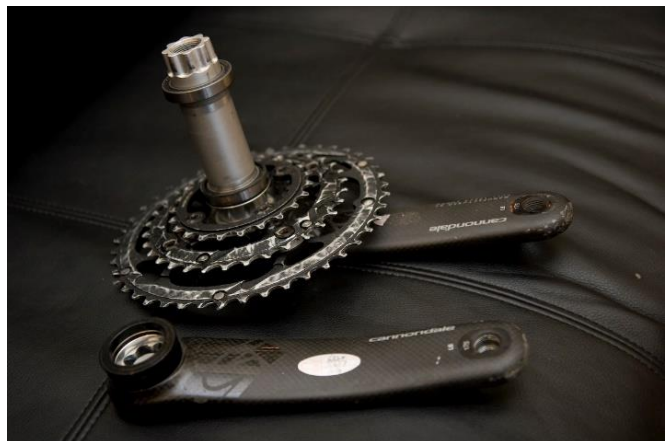
Obr. 29: Karbonové kliky Cannondale pro středové složení BB30 [42]
