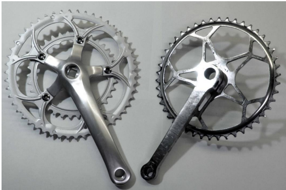
Obr. 13: Porovnání klik ze slitiny hliníku (nalevo) a klik z oceli (napravo) hmotnost ocelové kliky je 656 g, hmotnost hliníkové je 573 g, hliníková je lehčí i přesto, že má o jeden převodník navíc.
