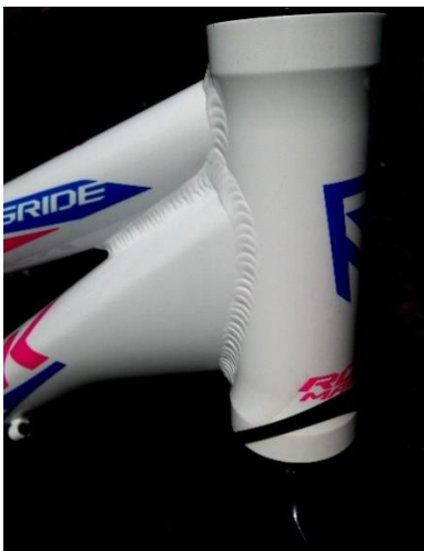
Obr. 9: Rám Rock Machine svařený technologií TIG
