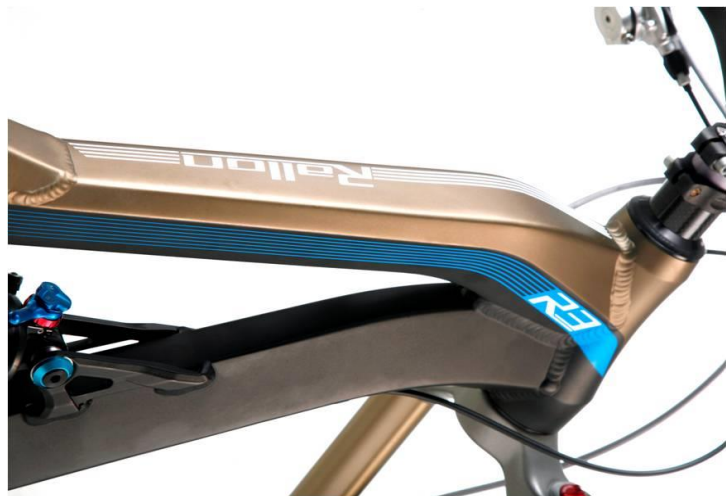
Obr. 10: Rám Orbea Rallon z trubek tvářených technologií hydroform [11]
