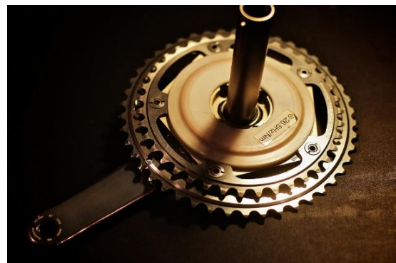
Obr. 25: Kliky s integrovanou osou značky SRM s wattmetrem určené pro středové složení Hollowtech II [35]
