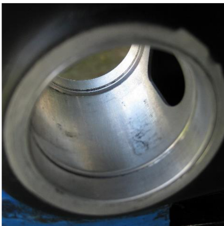
Obr. 28: Středový domek pro středové složení BB30 [41]
