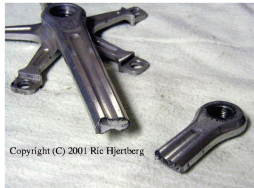
Obr. 39: Selhání kliky v oblasti největšího smykového napětí [53]
