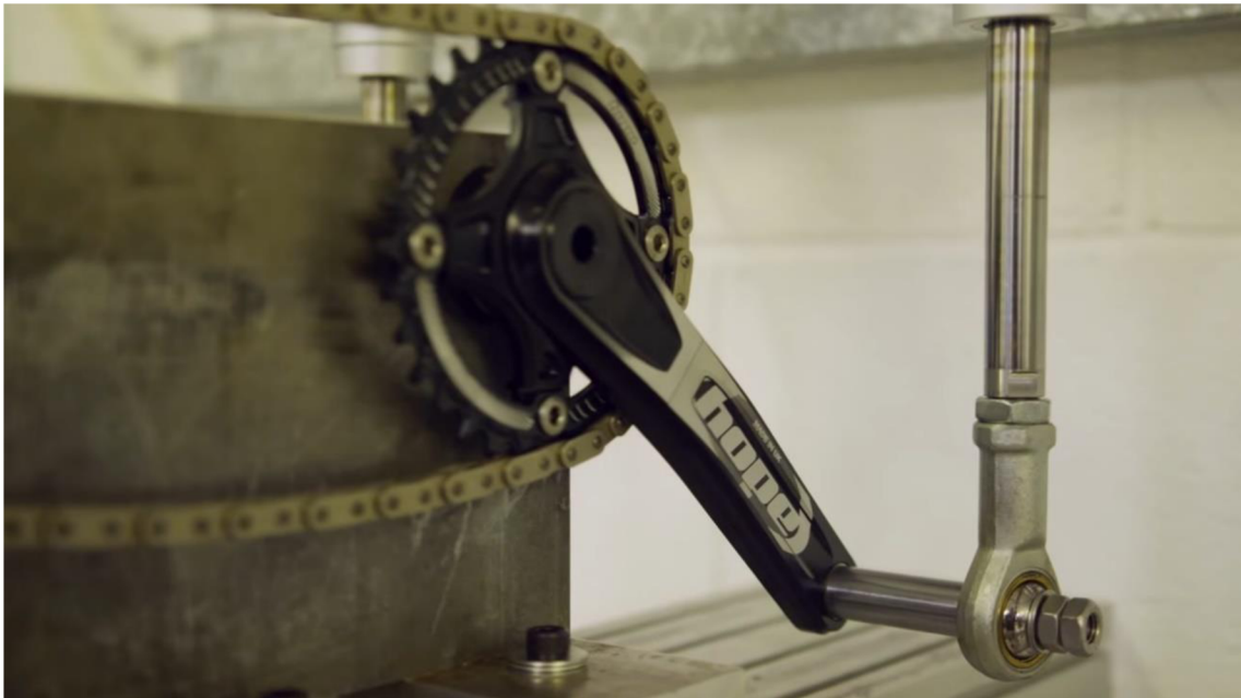
Obr. 33: Test simulující šlapání [48]
