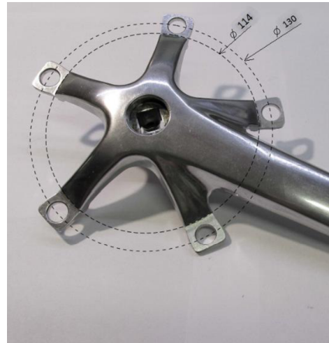
Obr. 32: Roztečná kružnice převodníkových děr a kružnice kopírující dosedací plochy převodník
