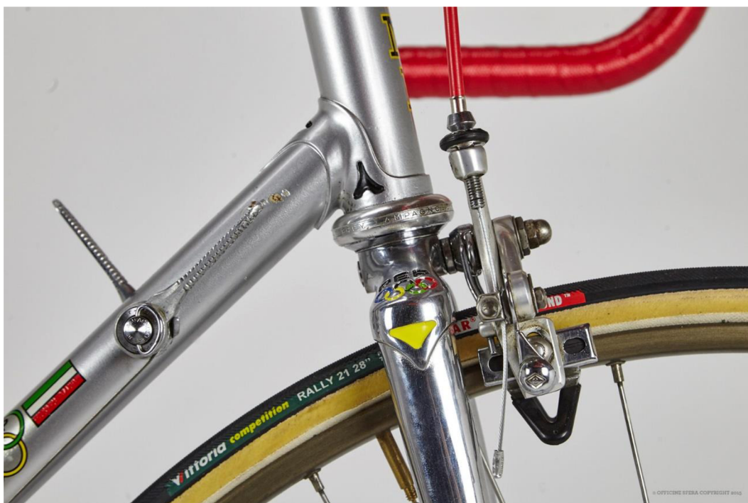
Obr. 8: Detailní pohled na spojení trubek pomocí mufní [9]
