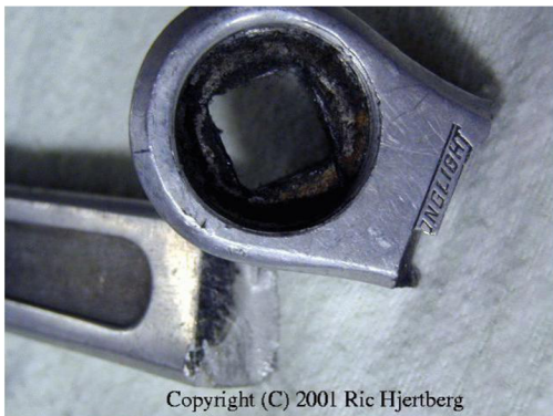
Obr. 38: Selhání kliky v oblasti největšího ohybového napětí, velkou roli hrál i vrub ve formě loga Stronglight [53]
