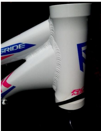
Obr. 9: Rám Rock Machine svařený technologií TIG
