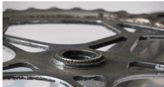
Obr. 46: O zajištění spideru by se postaral zalisovaný/roztemovaný přesahujícího nátrubek, podobně je to řešeno u kliky Favorit
