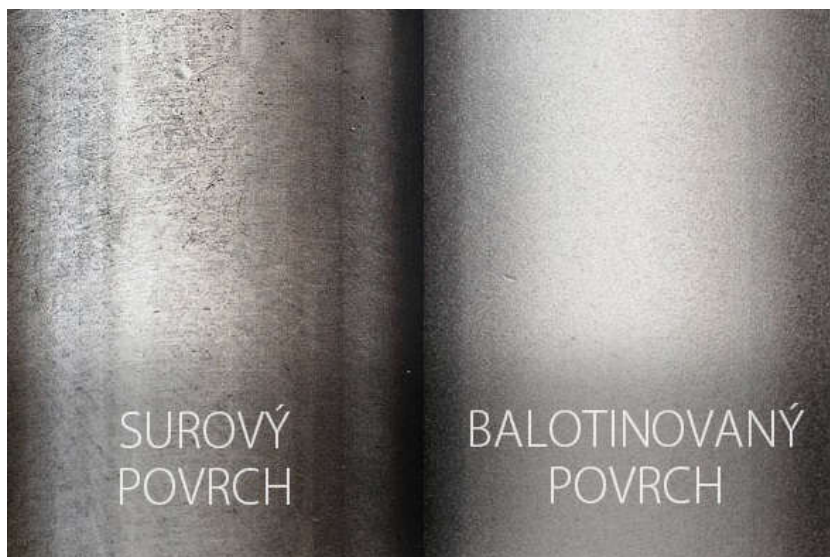
Obr. 11 Rozdíl mezi surovým povrchem a balotinovaným [12]
