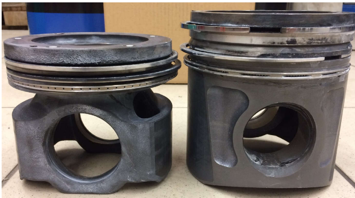
Obr. 10 Vlevo píst ocelový a vpravo píst z hliníkové slitiny [vlastní]
