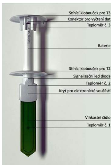
Obrázek 11: Vlhkostní sonda TOMST TMS-4 ( https://tomst.com/web/cz/systemy/tms/tms-4 ).
