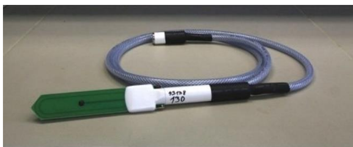
Obrázek 12: Vlhkostní sonda TOMST TMS-4 zakopávací ( https://eshop.tomst.com/tms-datalogery/90-tms-3-zakopavaci-1m.html ).
