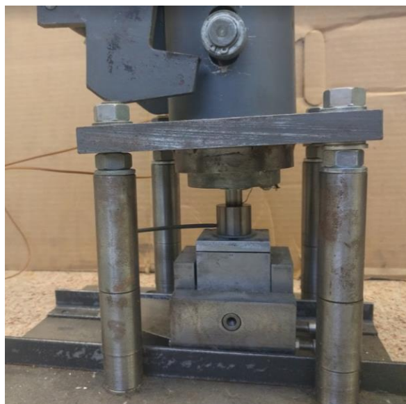
Obrázek 40: Odjištění spodního válce a vytvoření kontaktu mezi vzorkem a senzorem
