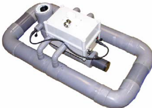
Obr. 4.8: Plovoucí rám se sonarem a laserovým měřičem [54]
