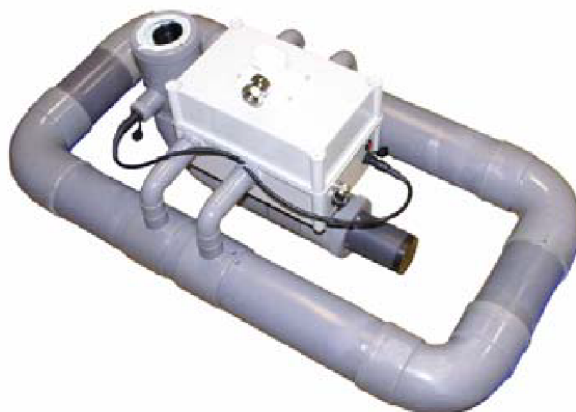
Obr. 4.8: Plovoucí rám se sonarem a laserovým měřičem [54]
