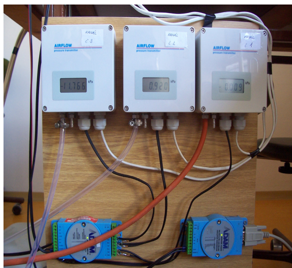
Obr.6.6: Převodníky tlaku AIRFLOW a moduly ADAM [12]
