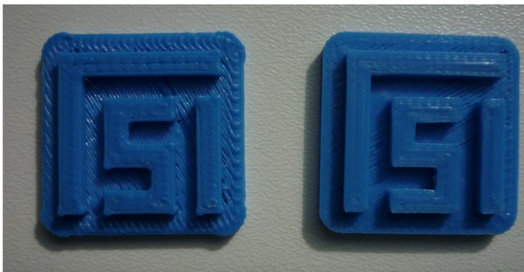
Obr. P1 Porovnání kvality tisku po vyladění parametrů
