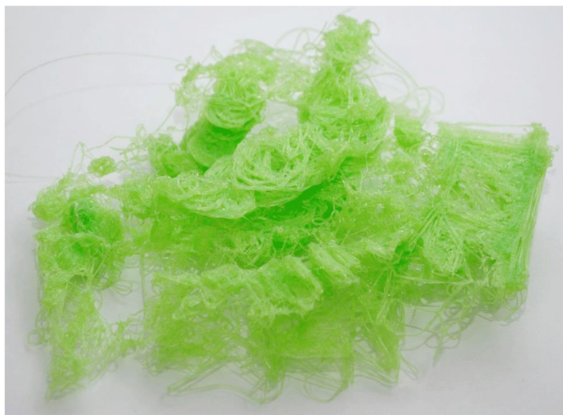
Obr. 11 Následek přilepení modelu k trysce[18].
