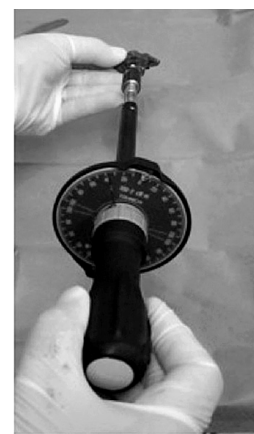
Obr. 4 a, b. Trajektorie předvrtání otvoru pro zavedení tahového šroubu (a) a zavedení šroubu pomocí momentového klíče (b).
