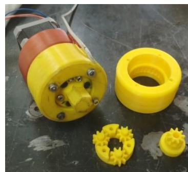
Obr. 36: Dvojitá planetová převodovka vytisknutá na 3D tiskárně
