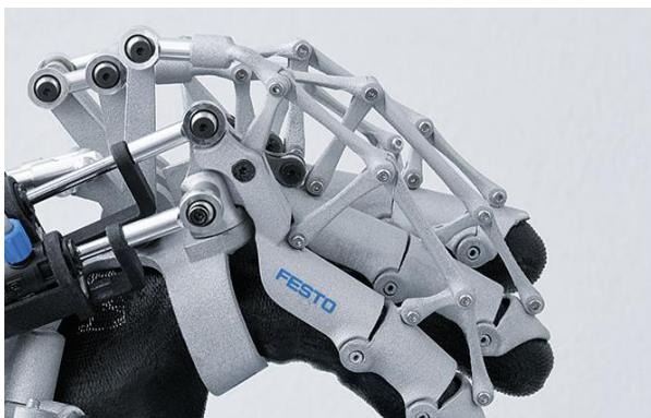
Obr. 38: Pohyb prstu pomocí vhodné sestavy pák (ExoHand) [33]
