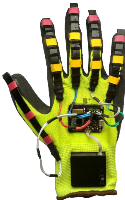
Obr. 63: Realizovaná ovládací rukavice
