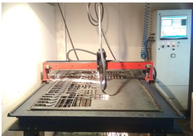
Obr. 23: Domácí CNC plazmová řezačka
