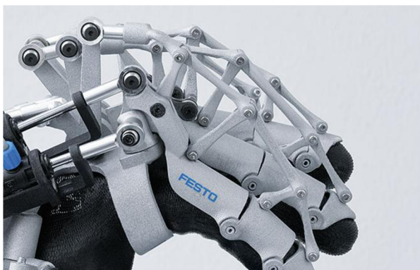
Obr. 38: Pohyb prstu pomocí vhodné sestavy pák (ExoHand) [33]
