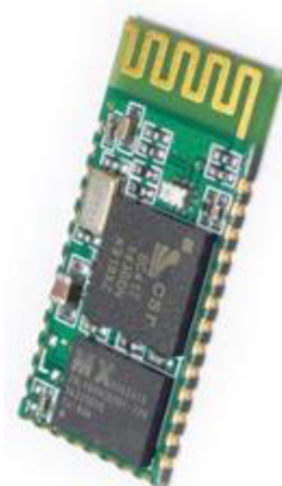
Obr. 24: Bluetooth modul HC-05 [28]
