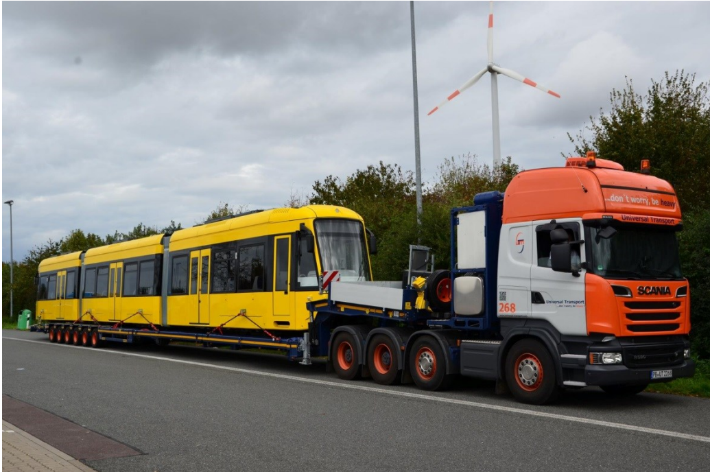
Obr. 1.16 Naložená trojčlánková tramvaj na kolejovém speciálu
