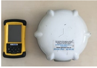
Obr. 3.4 Přístroj GNNS pro zaměření křižovatek
