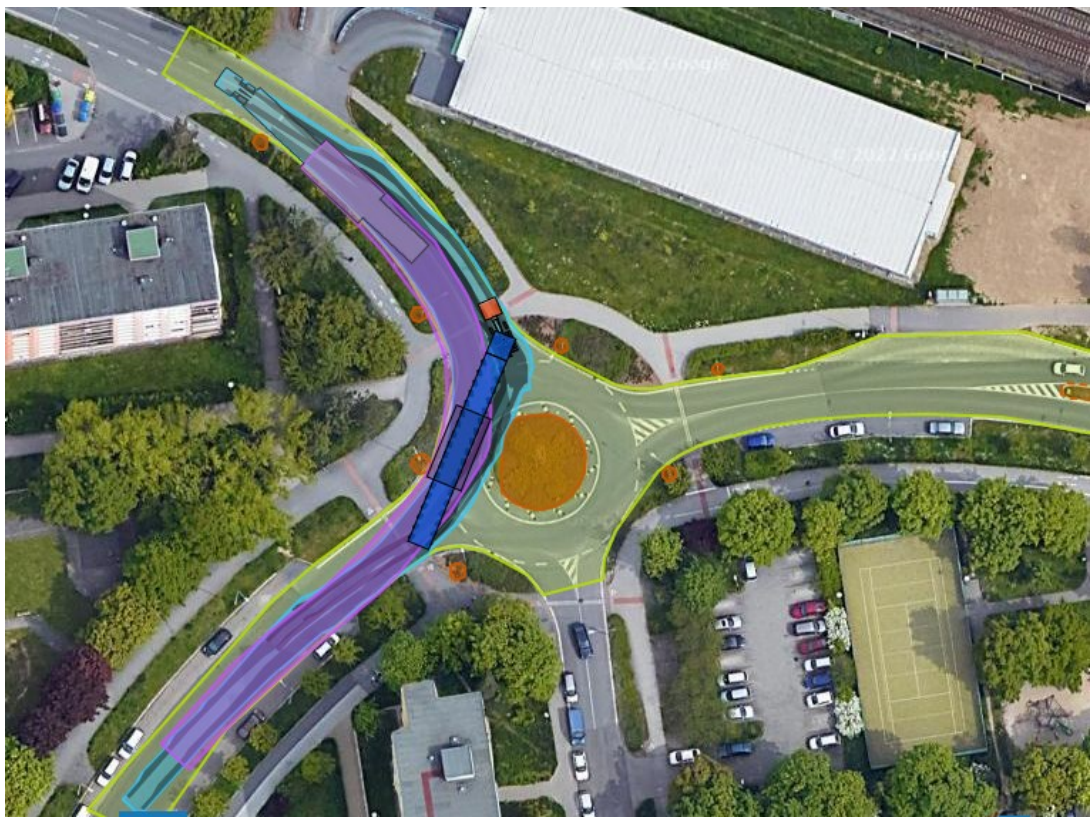
Obr. 4.8 Simulace průjezdu okružní křižovatky ulic Labkova a Volanova
