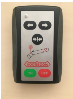
Obr. 1.4 Ovladač náprav pro návěsy Nooteboom
