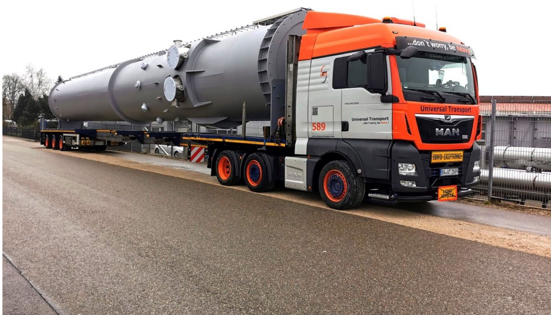
Obr. 1.8 Naložený teleskopický třínápravový návěs
