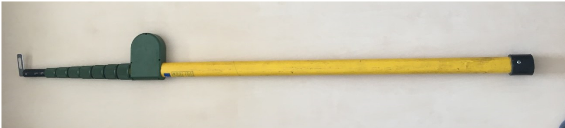
Obr. 3.2 Měřicí lať pro měření podjezdových výšek
