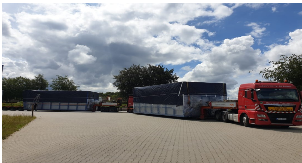
Obr. 1.10 Naložená souprava s třínápravovým hlubinným návěsem
