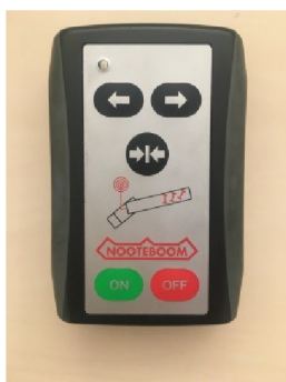
Obr. 1.4 Ovladač náprav pro návěsy Nooteboom
