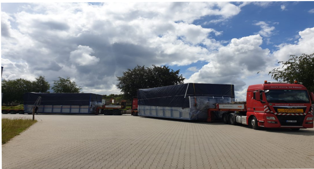
Obr. 1.10 Naložená souprava s třínápravovým hlubinným návěsem
