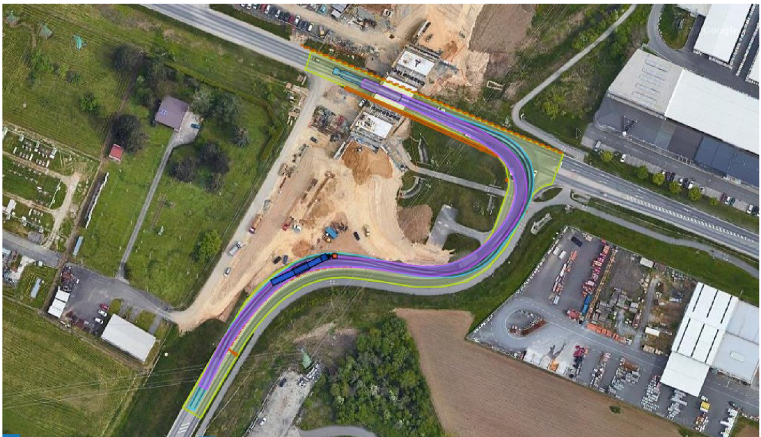
Obr. 4.9 Simulace průjezdu okružní křižovatky ulic Labkova a Volanova
