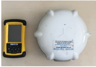
Obr. 3.4 Přístroj GNNS pro zaměření křižovatek
