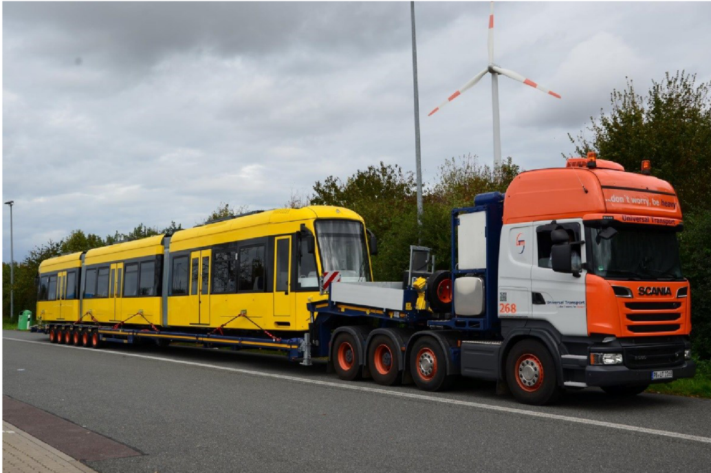
Obr. 1.16 Naložená trojčlánková tramvaj na kolejovém speciálu
