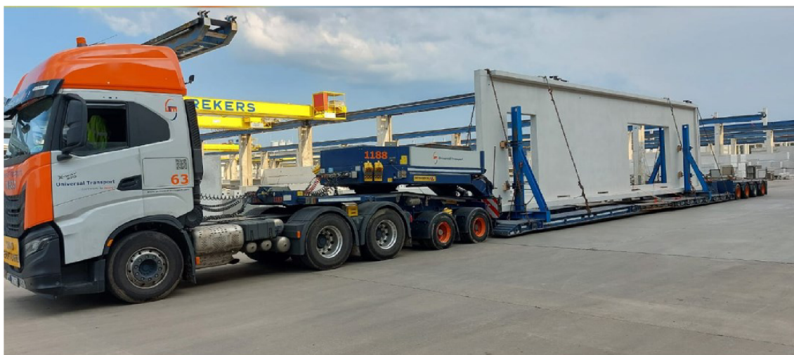
Obr. 1.12 Naložená souprava se sedminápravovým hlubinným návěsem a dolly
