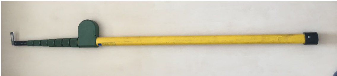
Obr. 3.2 Měřicí lať pro měření podjezdových výšek
