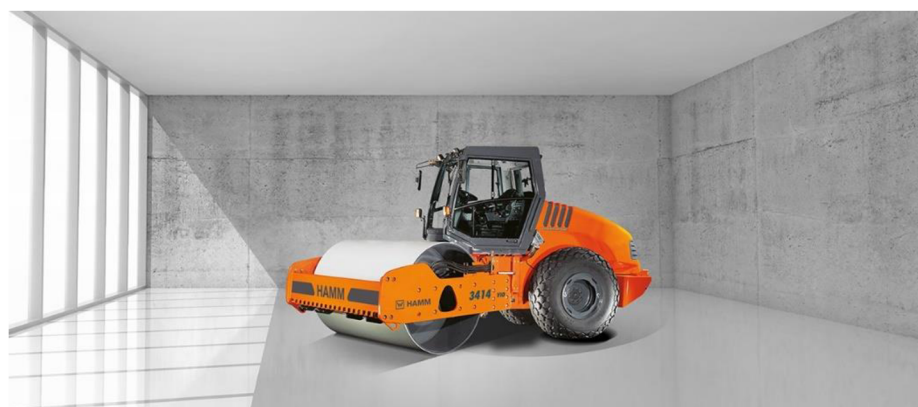
Obr. 10 Oscilační válec HAMM 3414 HT VIO s provozní hmotností 14010 kg
