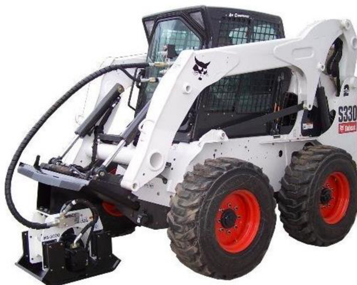
Obr. 16 Vibrační deska Eterra HS-3000 na smykem řízeném nakladači Bobcat S330 [24]
