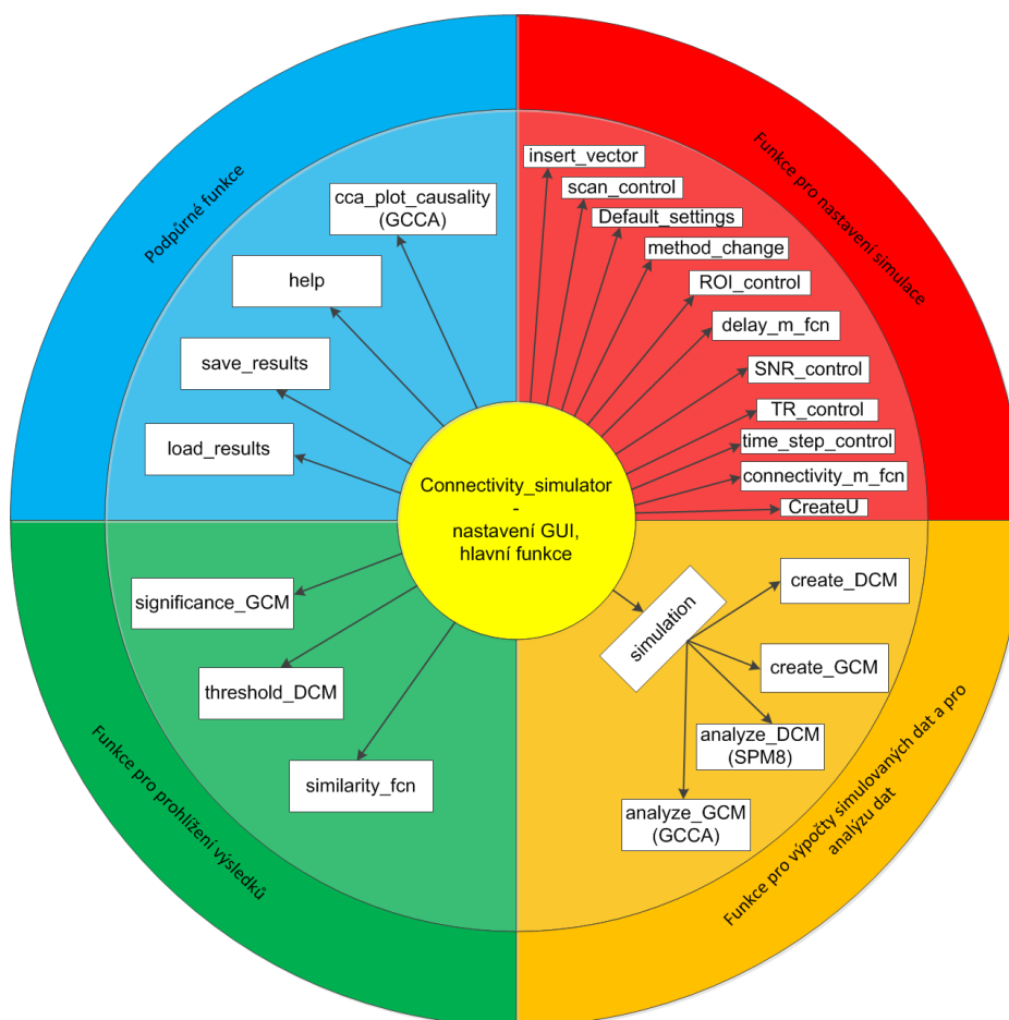
Obrázek 54: Vztahy mezi funkcemi zajišťujícími chod nástroje Connectivity_simulator
