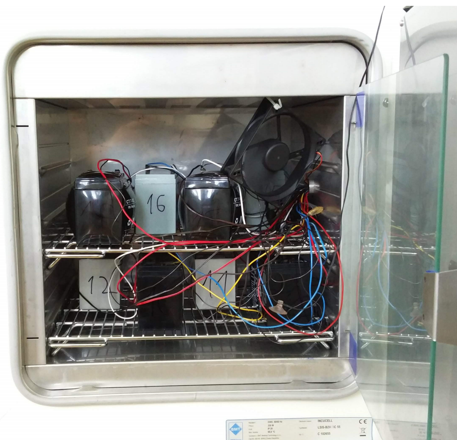
Obr. 2.15: Temperační pec s akumulátory doplněna 120mm ventilátorem pro zajištění nuceného proudění.
