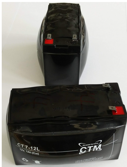
Obr. 2.19: Nádoba akumulátoru č.2 zdeformovaná extrémně vysokou teplotou.
